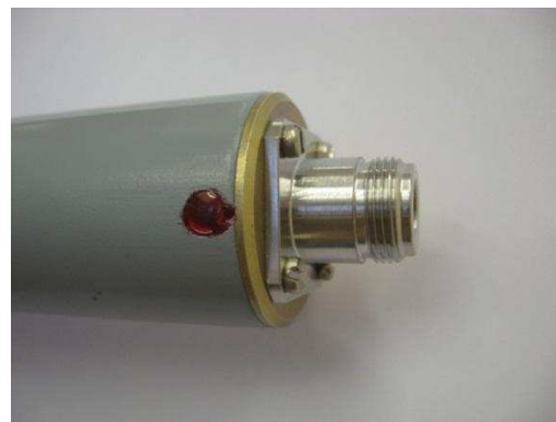
Фото 3. Антенна П6-121М1 разъем N-типа
