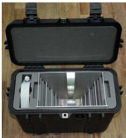
Фото 3. Антенна П6-123 в пыле-влагозащитном противоударном корпусе
