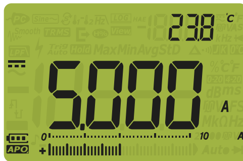
Рис. 2–24 Отображение силы постоянного тока
