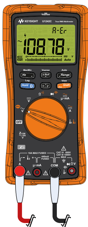
Рис. 1–2 Пример неправильного присоединения входных проводов к разъемам
