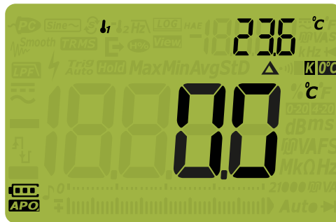
Рис. 2–22 Измерение температуры без компенсации влияния температуры окружающей среды
