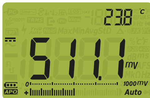
Рис. 2–4 Отображение напряжения постоянного тока
