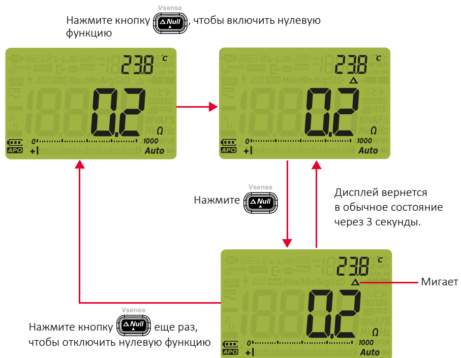
Рис. 3–4 Принцип работы нулевой функции
