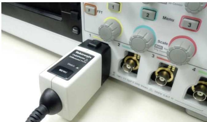
Интерфейс TekVPI осуществляет передачу информации о коэффициентах масштабирования, выбранных диапазонах и настройках между пробником и осциллографом TBS2000.
