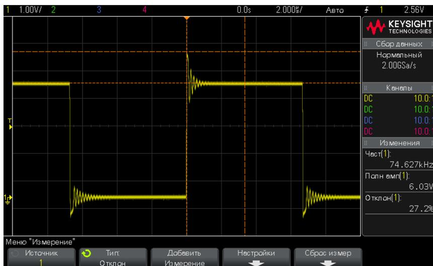
**Рис. 46** Автоматическое измерение отклонения от установленного значения
