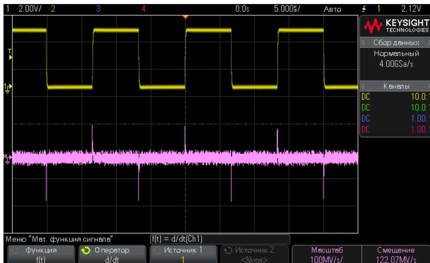
Рис. 7 Пример функции дифференцирования
