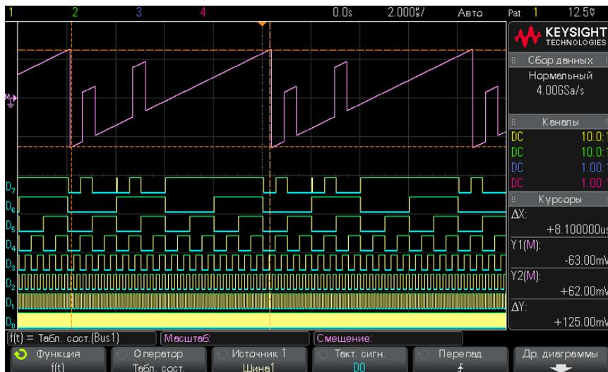
**Рис. 19** Пример графика состояния логической шины
