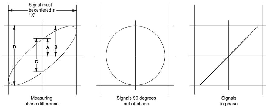
**Рис. 3** Сигналы в режиме "XY", центрированные на экране
