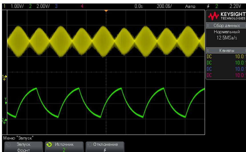
Рис. 26 Отображение амплитудной модуляции при яркости 40/
