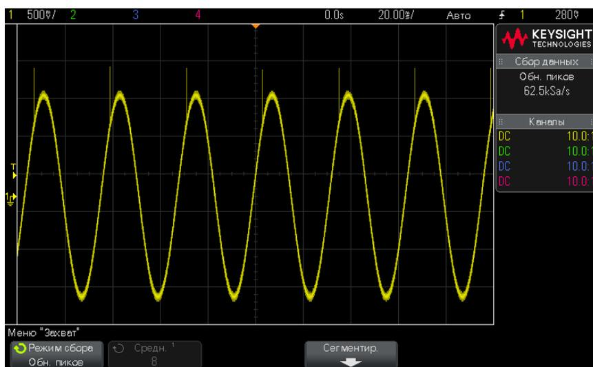
**Рис. 37** Синусоида с импульсной помехой, режим обнаружения пиков
