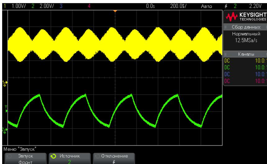
Рис. 25 Отображение амплитудной модуляции при яркости 100/
