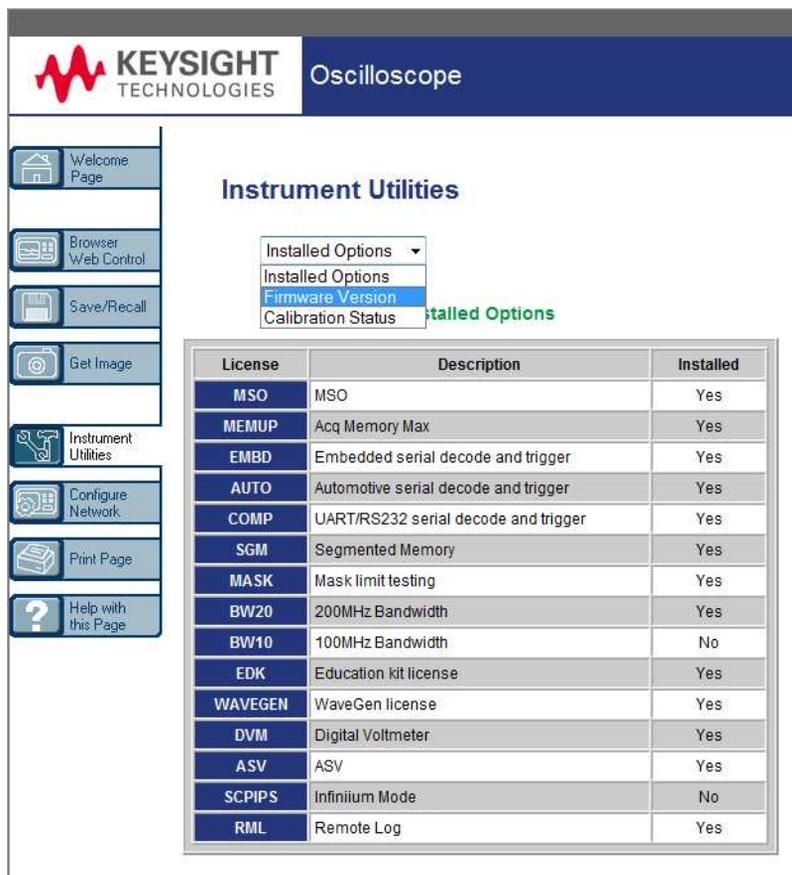
**KEYSIGHT TECHNOLOGIES** Oscilloscope
