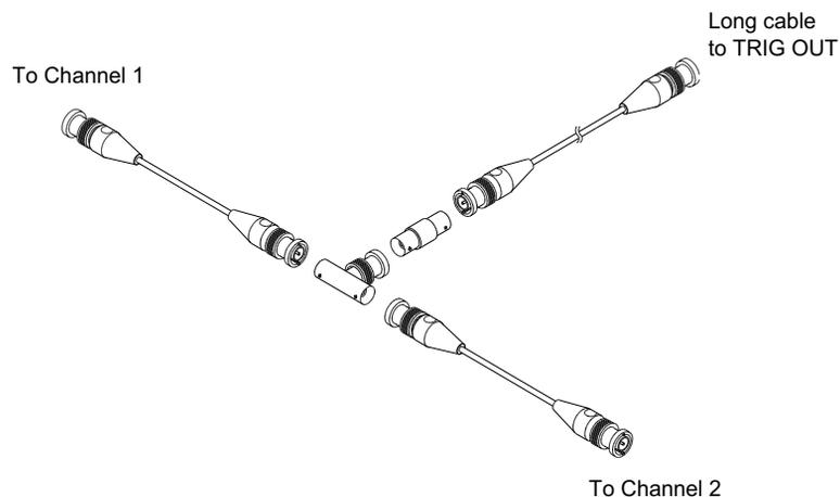
**Рис. 48** Соединение кабелей для пользовательской калибровки двухканального осциллографа
