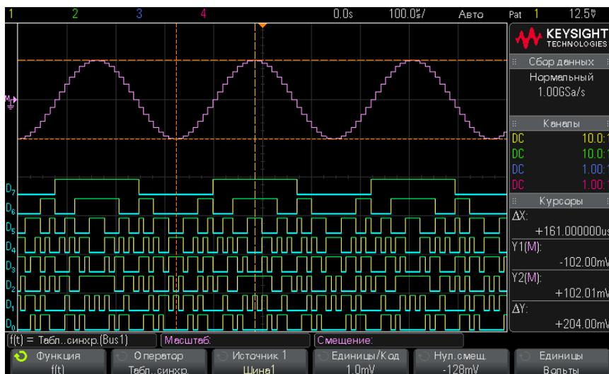
**Рис. 18** Пример графика синхронизации логической шины
