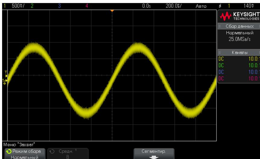
Рис. 38 Случайные шумы на отображаемом сигнале
