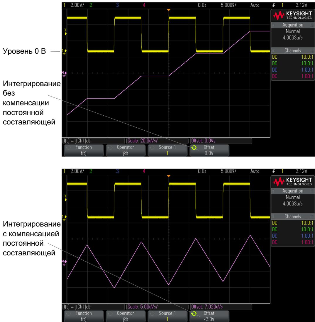
Рис. 8 Интегрирование и смещение сигнала
