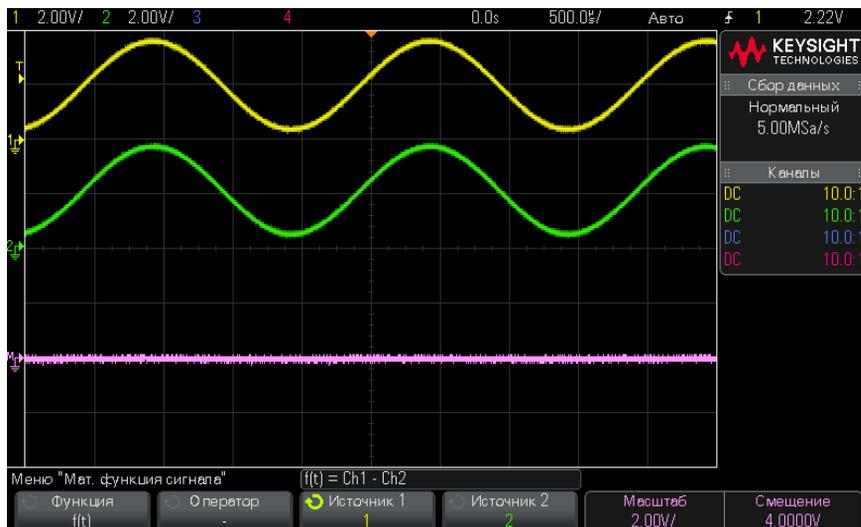
Рис. 5 Пример вычитания сигнала канала 2 из сигнала канала 1
