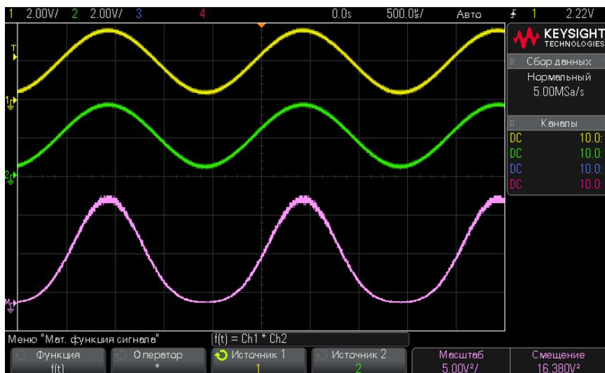
**Рис. 6** Пример умножения сигнала Channel 1 на сигнал Channel 2
