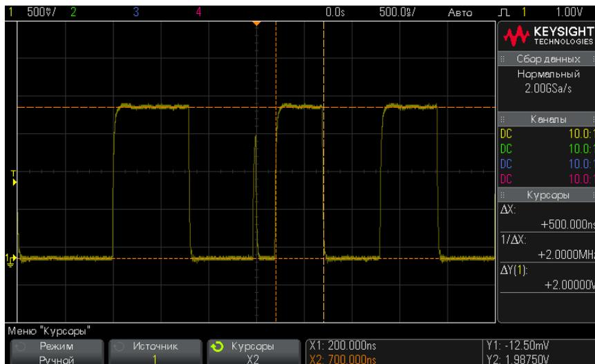
**Рис. 43** Измерение длительности импульса с помощью курсоров
