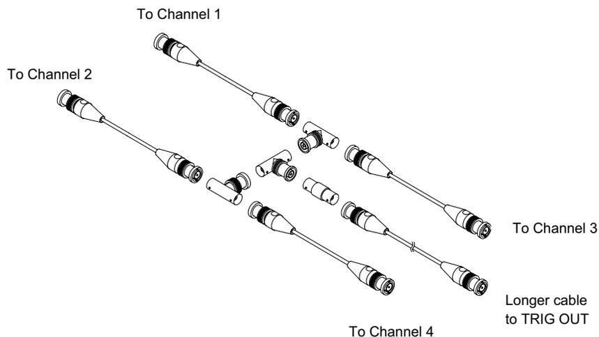
**Рис. 49** Соединение кабелей для пользовательской калибровки четырехканального осциллографа
