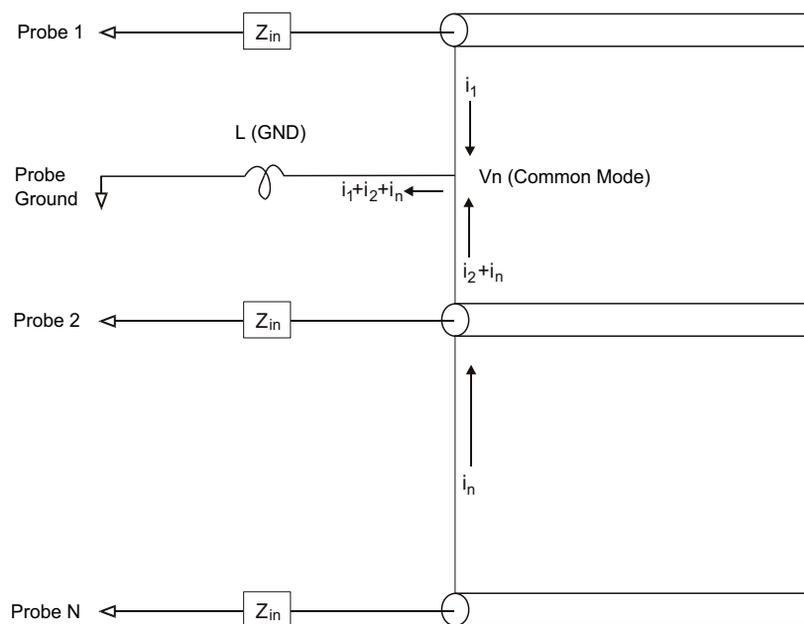
**Рис. 24** Схема формирования синфазного входного напряжения
