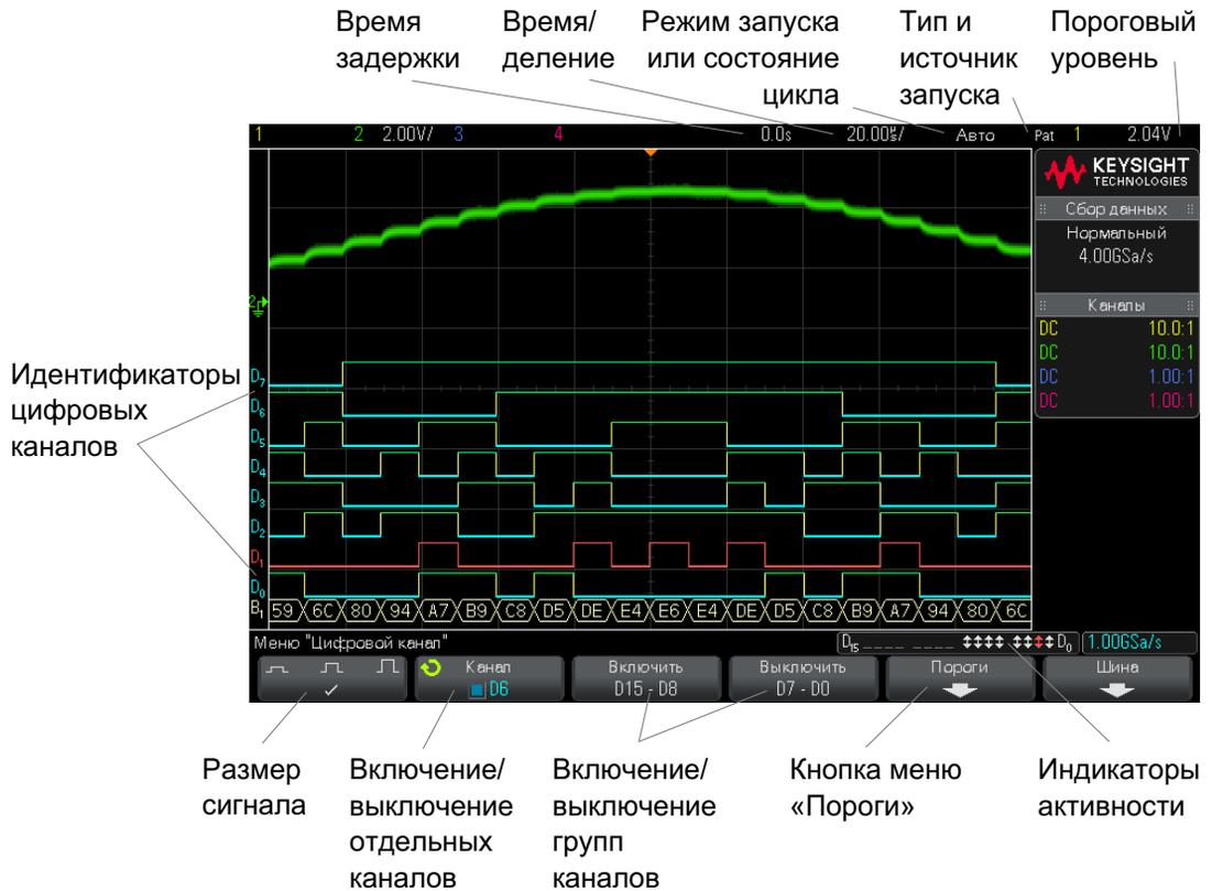
**Индикатор активности** Если включен какой-либо цифровой канал, в строке состояния внизу экрана будет показан индикатор активности. Цифровой канал может находиться в постоянно высоком (■), постоянно низком (■) или переключаемом логическом состоянии (↕). При выключении любого канала его индикатор отображается серым цветом.
