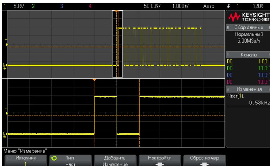
**Рис. 47** Локализация события с целью измерения частоты
