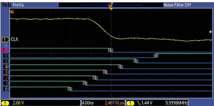
Белые фронты означают, что захват сигнала с более высокой частотой дискретизации может дать дополнительную информацию.
