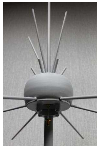
Фото 4. Антенна АС7.38 SMA разъем
