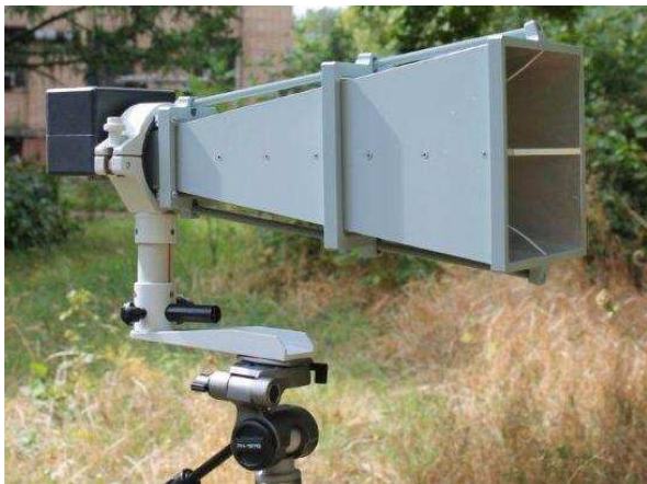
Фото 1. Антенна П6-126 на узле крепления АК-02
