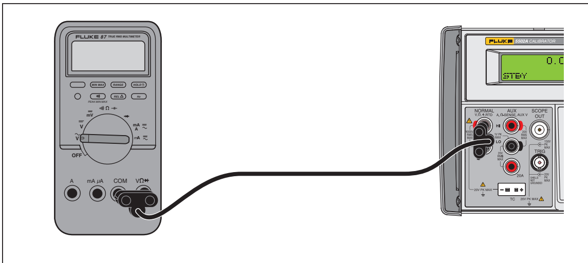
Рисунок 4-15. Подключение кабелей для тестирования общей функциональности устройств серии 80
