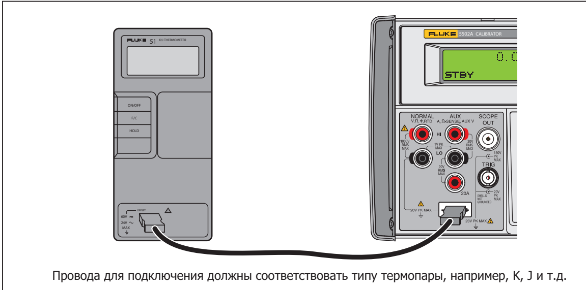
Рисунок 4-10. Подключение испытываемого устройства: Температура (Термопара)
