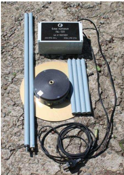
Фото 1. Антенна П6-120 в разобранном виде
