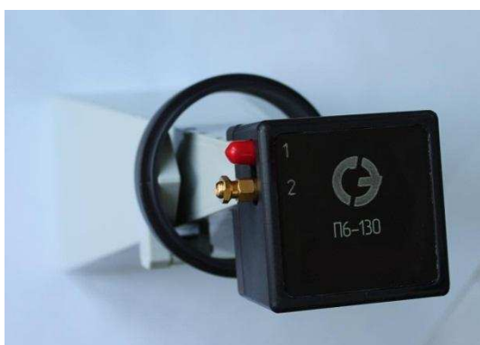
Фото 1. Антенна П6-130, фазовращатель
