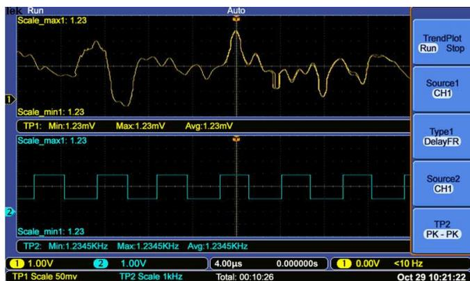
Для поиска перемежающихся сбоев используется функция TrendPlot™, с помощью которой можно выполнять мониторинг измерений в течение длительного времени.
