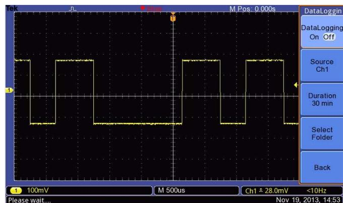
Функция регистрации данных позволяет автоматически сохранять захваченные сигналы.
