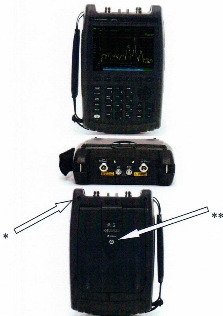
Рисунок 1 - Анализатор с разъемами N - типа по ГОСТ 13317 – 89
