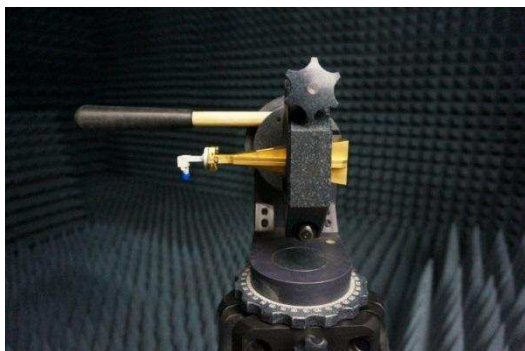
Фото 1. Антенна П6-134 на диэлектрическом штативе ШАД-01
