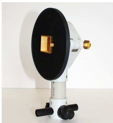
Фото 1. Антенна П6-134 на диэлектрическом штативе ШАД-01
