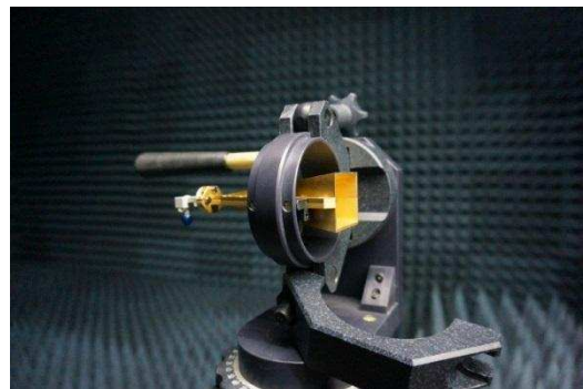
Фото 2. Антенна П6-134 на диэлектрическом штативе ШАД-01
