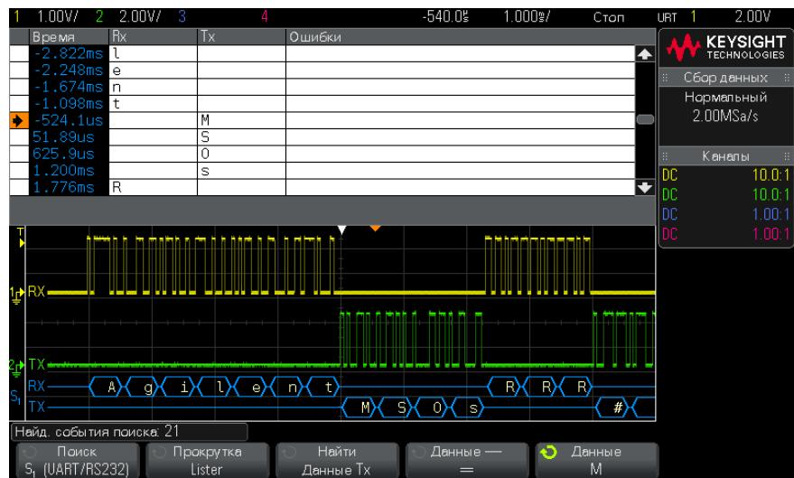
Каждая опция декодирования последовательных данных позволяет вам находить характерные для протокола заголовки, данные, ошибки и пр. Обращайтесь к следующим описаниям.
