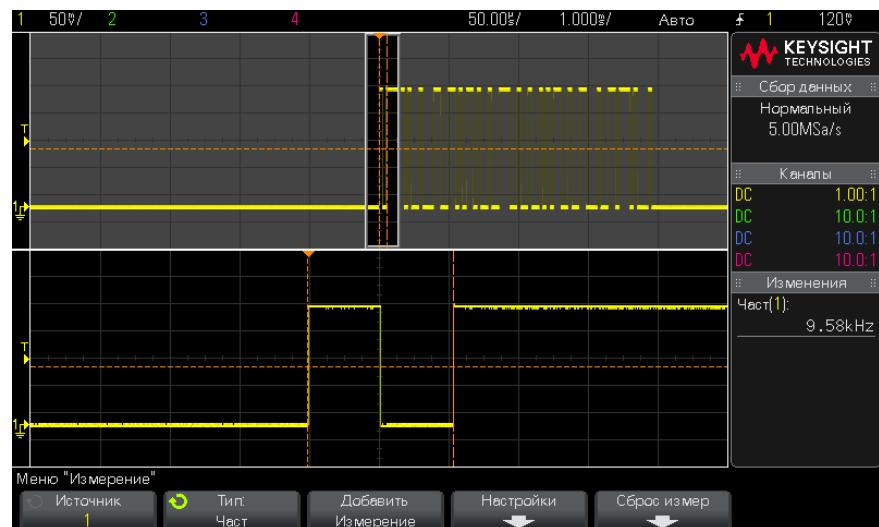
**Рис. 35** Локализация события с целью измерения частоты
