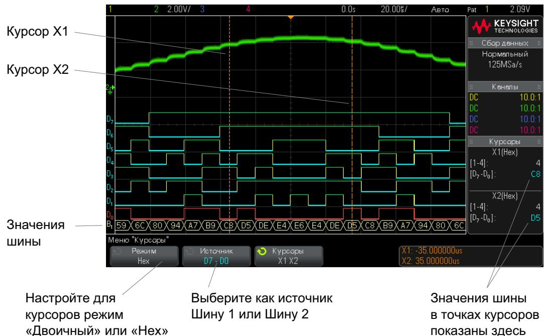
При нажатии кнопки **[Digital] (Цифров.)** с целью отобразить меню "Цифровой канал", на месте значений курсоров отображается цифровой индикатор активности, а в координатной сетке – значения шин в точках расположения курсоров.
