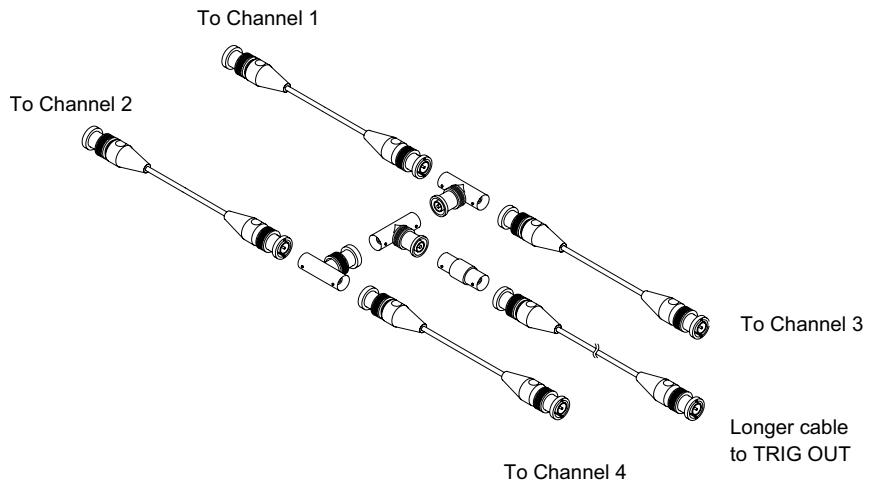
**Рис. 37** Соединение кабелей для пользовательской калибровки четырехканального осциллографа
