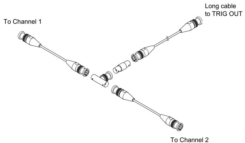
**Рис. 36** Соединение кабелей для пользовательской калибровки двухканального осциллографа
