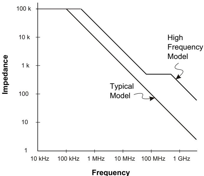
**Рис. 11** Зависимость импеданса от частоты для схем цепи пробников обоих моделей
