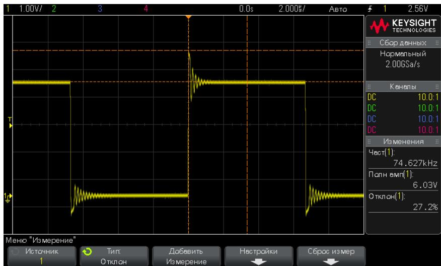
**Рис. 34** Автоматическое измерение отклонения от установленного значения
