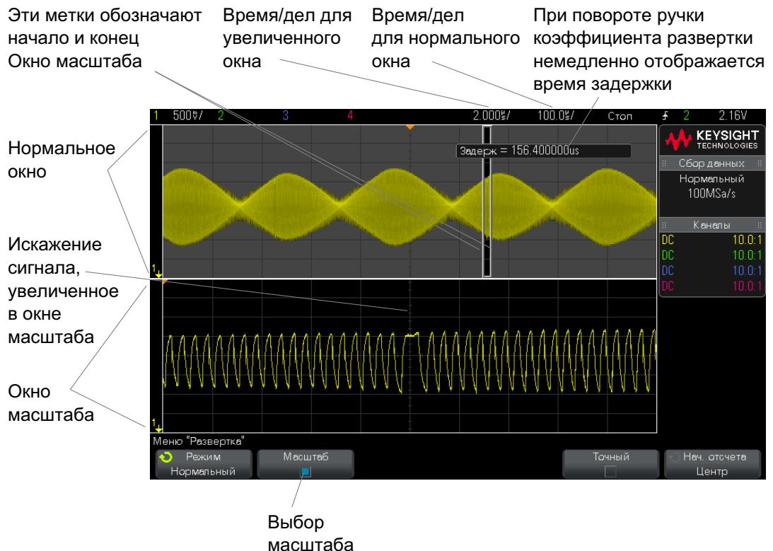
Область растяжения нормального экрана очерчивается прямоугольником, остальная часть экрана затеняется. Прямоугольник с областью растяжения нормального экрана отображается в нижней половине экрана.
