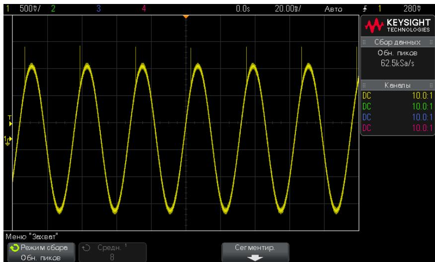
**Рис. 25** Синусоида с импульсной помехой, режим обнаружения пиков
