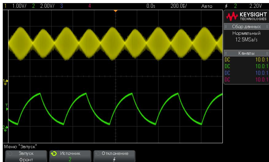
Рис. 14 Отображение амплитудной модуляции при яркости 40/
