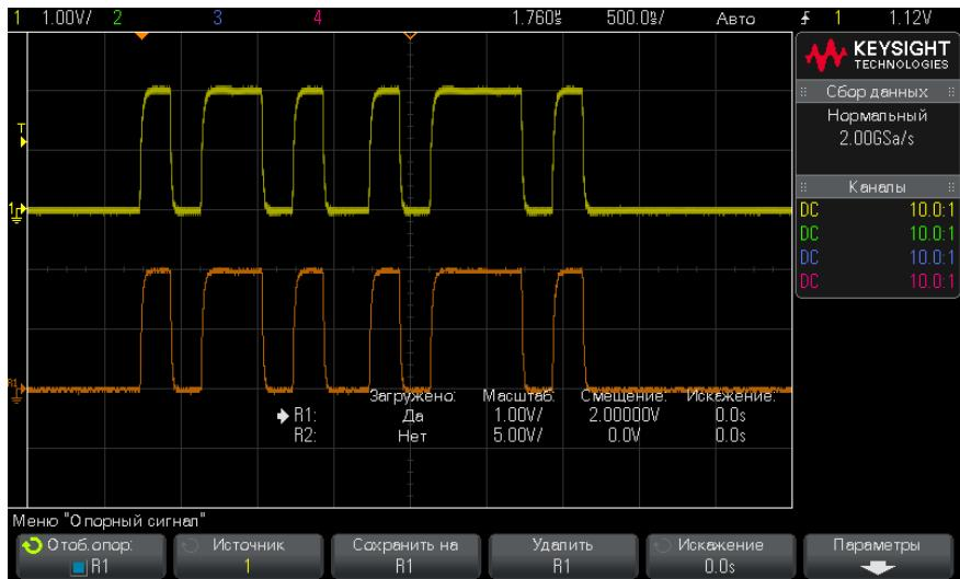
Только один опорный сигнал можно отобразить одновременно.
