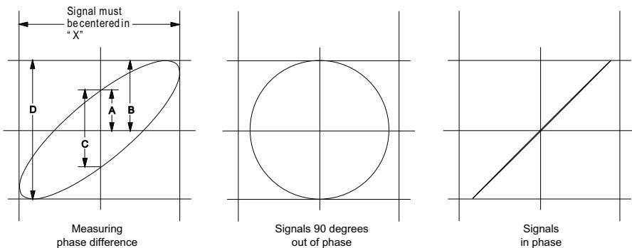
**Рис. 3** Сигналы в режиме "XY", центрированные на экране
