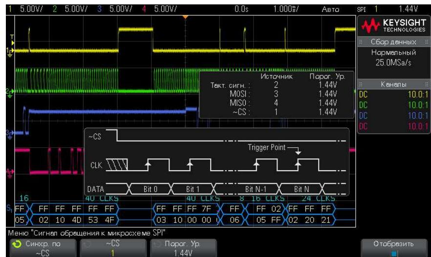
В меню "Сигнал обращения к микросхеме SPI" выполните следующие действия.
