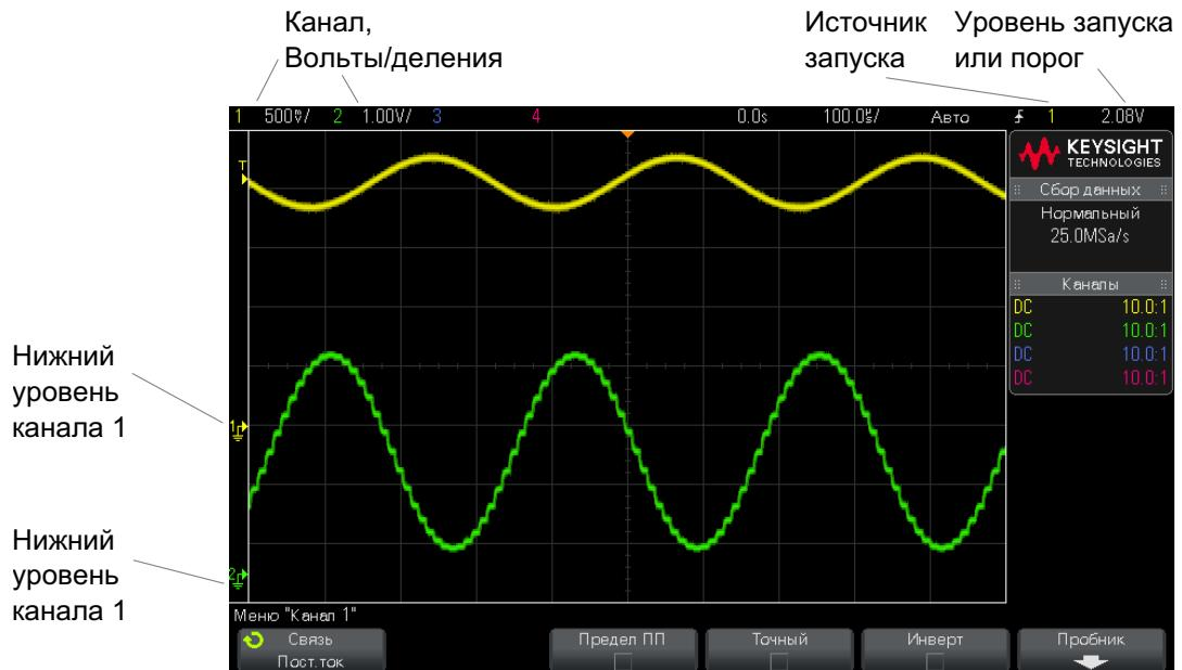
Уровень заземления сигнала для каждого отображаемого канала определяется по положению значка в крайней левой части экрана.
