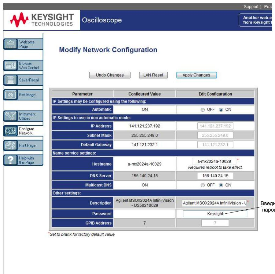
Чтобы получить доступ к осциллографу, защищенному паролем, в качестве имени пользователя необходимо указать IP-адрес осциллографа.
