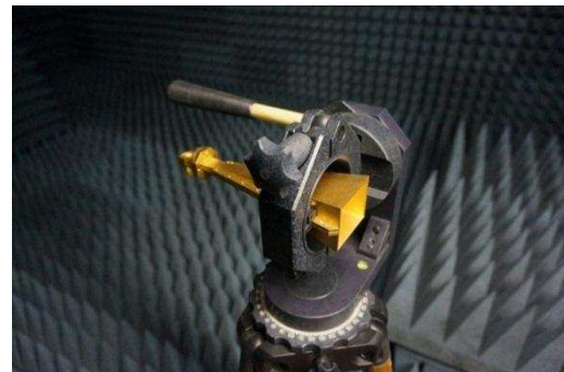
Фото 2. Антенна П6-133 на диэлектрическом штативе ШАД-01
