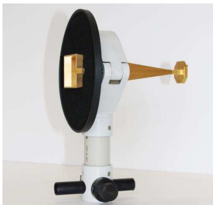
Фото 1. Антенна П6-133 на диэлектрическом штативе ШАД-01
