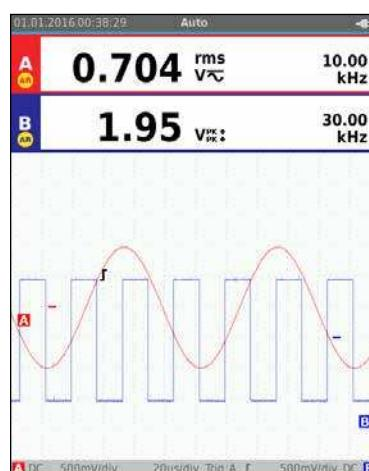
Автоматический пуск Connect-and-View™ с функцией автоматического получения показаний Fluke IntellaSet™ обеспечивает быстрый доступ к необходимым данным.
