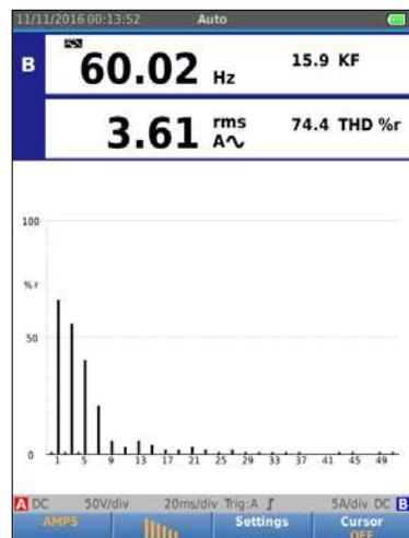
Обзор спектра гармоник с использованием курсора для измерения искажений в форме процентов основной гармоники.
