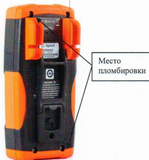
Рисунок 2 - Задняя панель мультиметров
