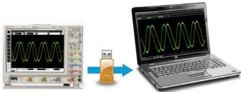
Просматривайте и анализируйте результаты измерений на своем рабочем месте. Сохраните данные осциллографа в файл и далее просматривайте и анализируйте их на ПК без необходимости дополнительного доступа к осциллографу.
