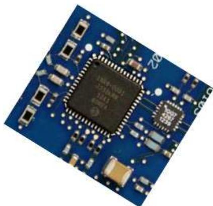
Входные тракты в приборах серии S содержат три новые специализированные ИМС, в том числе изготовленную по биполярной КМОП-технологии 130 нм ИМС, которая содержит в себе выбираемые пользователем аналоговые фильтры и возможности модернизации полосы пропускания путем установки лицензии на ПО.
