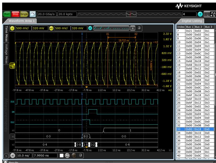
Цифровые каналы позволяют оценивать, как соотносятся между собой сигналы управления и шины данных с разрядностью до 16 бит. Для быстрой интерпретации сигналов вы можете использовать отображение символов.
