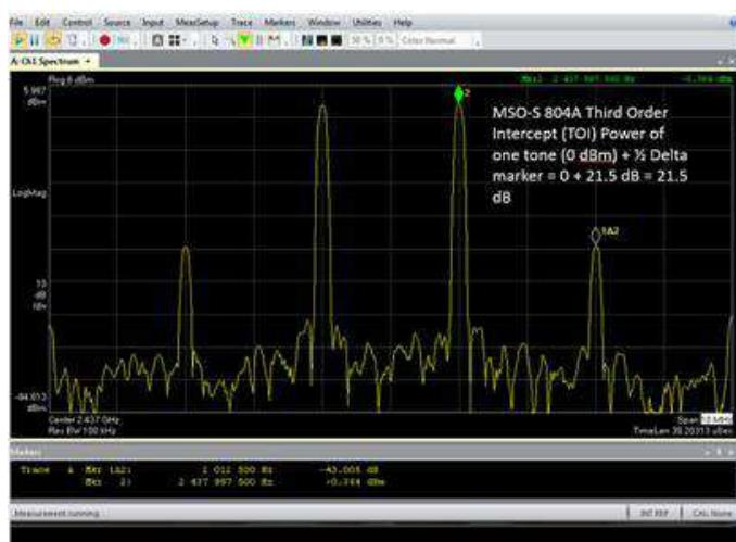
Векторный анализ сигналов с использованием данных, захваченных осциллографом серии S, показывает отличное значение интермодуляционной составляющей третьего порядка, равное 25 дБм.
