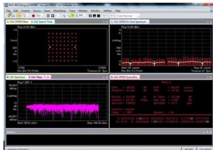
Векторный анализ сигналов с использованием данных, захваченных осциллографом серии S, показывает амплитуду вектора ошибок для 64-кратной квадратурно-амплитудной модуляции (64-QAM) по IEEE 802.11, равную 0,47 %.
