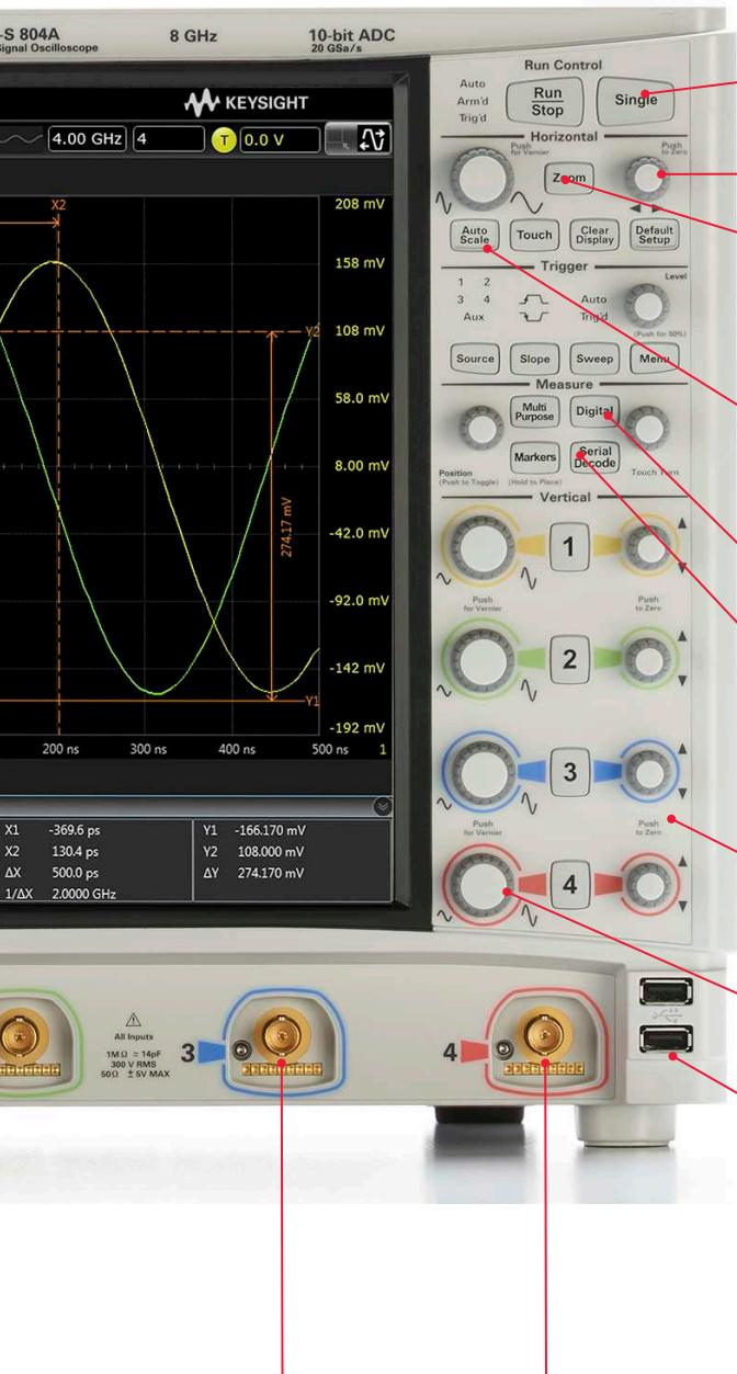
Наличие отдельной кнопки Single (Единичный) для однократного захвата позволяет лучше управлять процессом захвата уникального события
