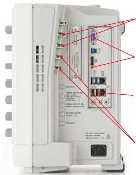
Встроенные порты входа-выхода опорного сигнала 10 МГц обеспечивают синхронизацию нескольких измерительных приборов в системе
