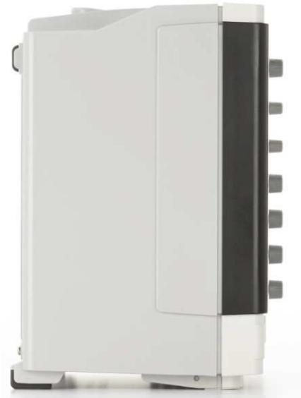
Осциллографы Infiniium серии S обладают полосой пропускания от 500 МГц до 8 ГГц. Каждая модель имеет большой емкостный сенсорный XGA-дисплей с диагональю 15 дюймов (38,1 см). Осциллографы имеют компактную конструкцию глубиной всего 9 дюймов (23 см).
