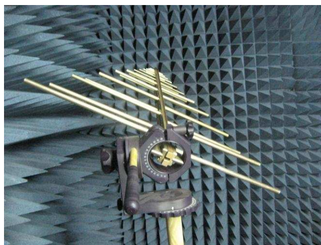
Фото2. Вариант крепления П6-122 на штатив
