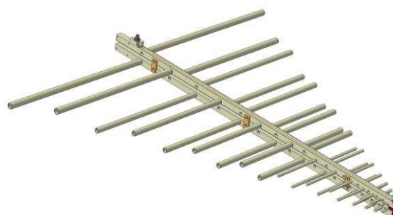
Рис.2 3D модель антенны П6-122
