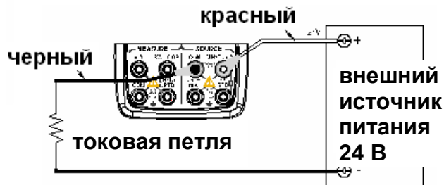
Рисунок 9. Формирование постоянного тока в токовой петле с внешним источником питания
