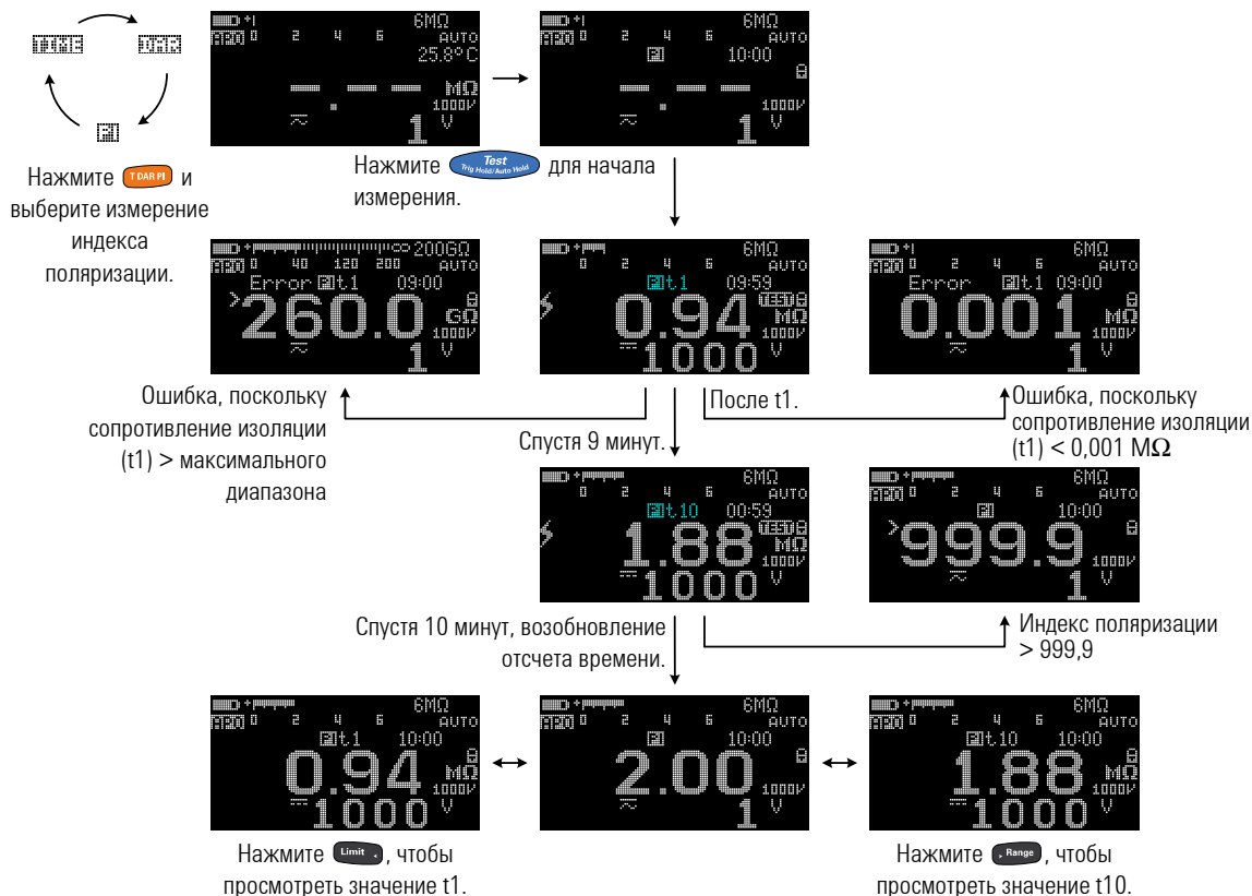
Рис. 2-4 Измерение индекса поляризации
