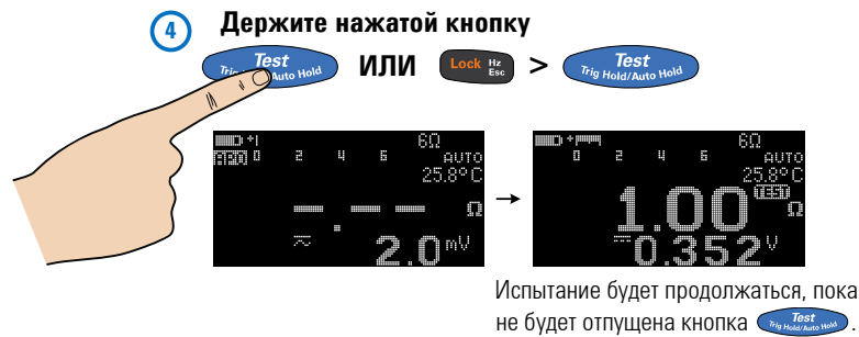
Рис. 2-10 Пример измерения сопротивления заземления
