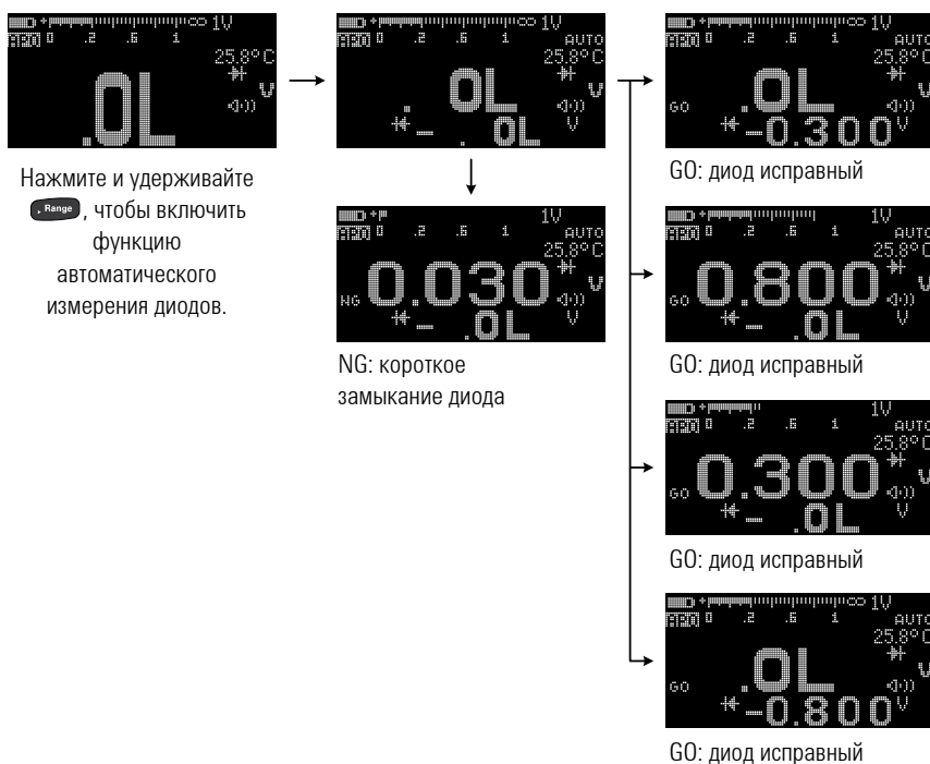
Рис. 2-20 Операция автоматического измерения диодов
