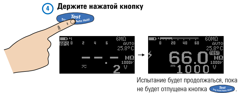
Рис. 2-1 Пример проверки сопротивления изоляции
