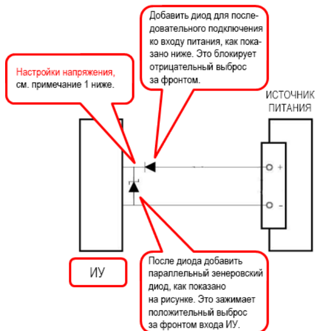
Рисунок 2-2 Рекомендуемая схема соединений для защиты от выбросов напряжения
