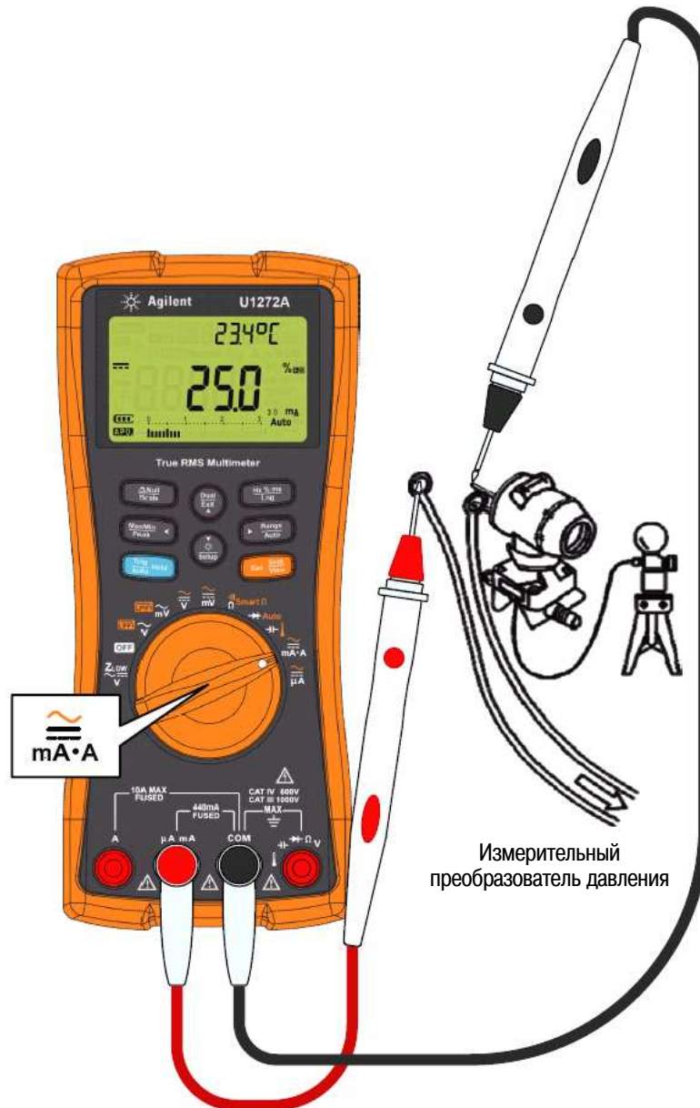
Рис. 2-34 Измерение процентного значения тока в диапазоне 4 ÷ 20 мА
