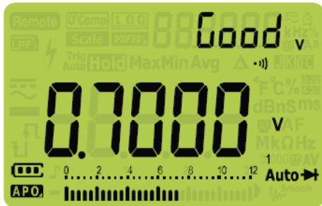
Рис. 2-22 Индикация в режиме автоматической проверки диодов – исправный диод
