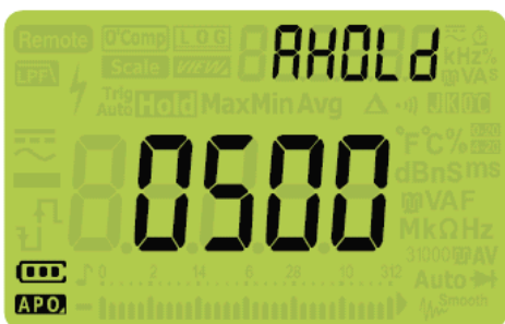
Рис. 4-3 Дисплей параметра AHOLD
