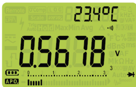
Рис. 2-18 Вид дисплея при проверке диода
