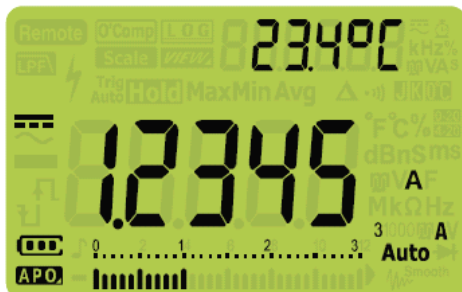
Рис. 2-29 Индикация постоянного тока
