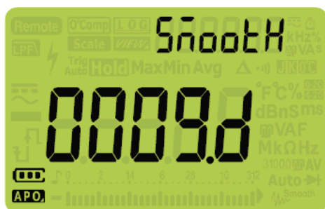
Рис. 4-18 Дисплей параметра SMootH
