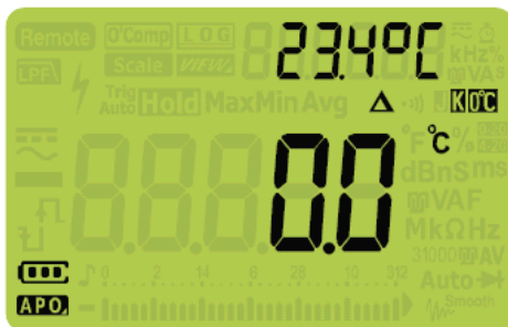
Рис. 2-28 Измерение температуры без компенсации температуры окружающей среды
