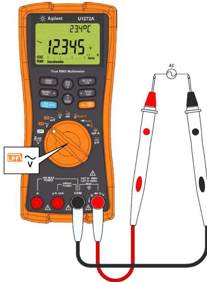
Рис. 2-2 Измерение переменного напряжения
