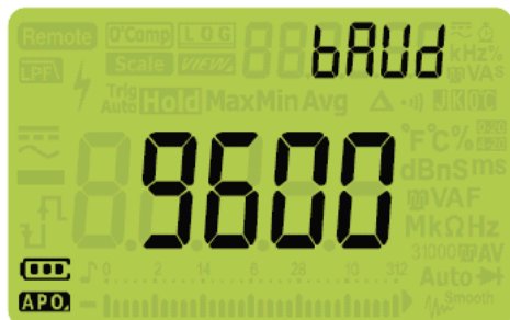
Рис. 4-14 Дисплей параметра bAUd
