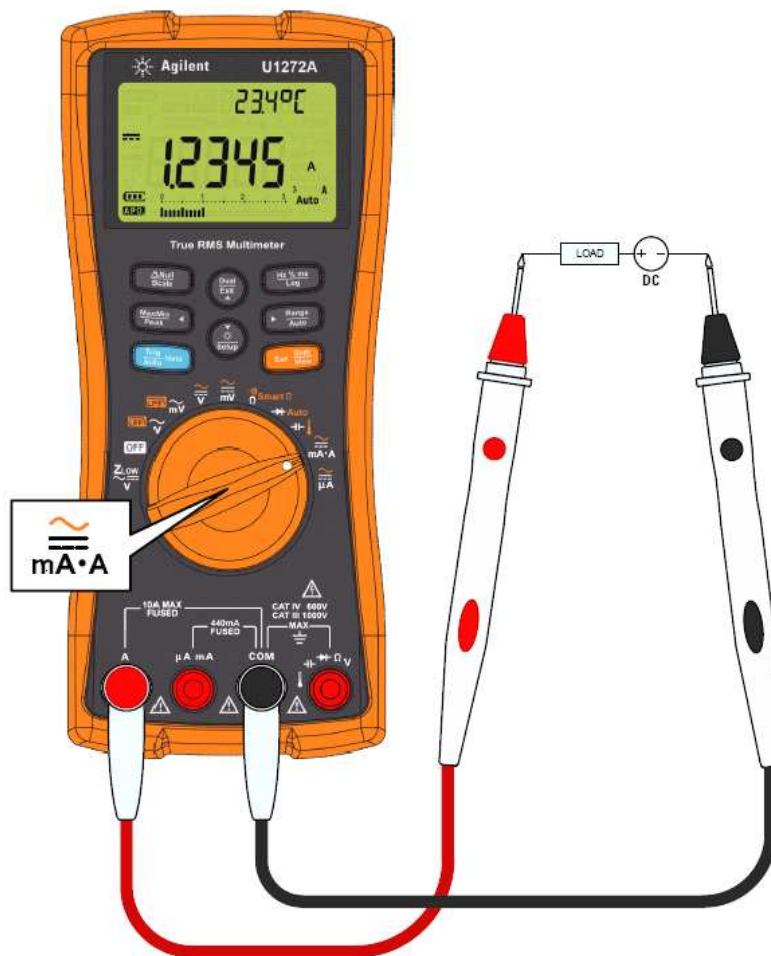
Рис. 2-30 Измерение постоянного тока
