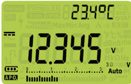
Рис. 2-5 Индикация постоянного напряжения
