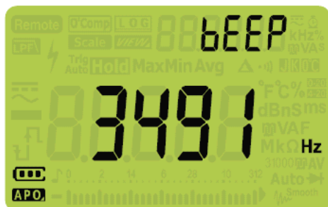
Рис. 4-1 Дисплей параметра bEEP
