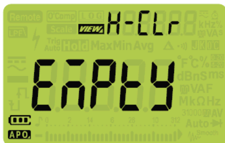
Рис. 3-11 Вид дисплея при отсутствии зарегистрированных данных
