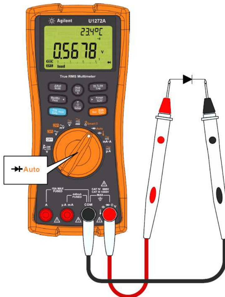
Рис. 2-20 Проверка диода при прямом смещении
