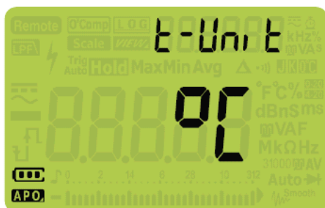
Рис. 4-21 Дисплей параметра t-Unit
