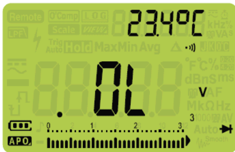
Рис. 2-19 Индикация для перегоревшего диода
