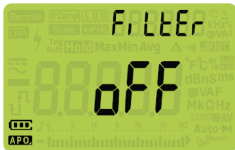
Рис. 4-2 Дисплей параметра FilTEr
