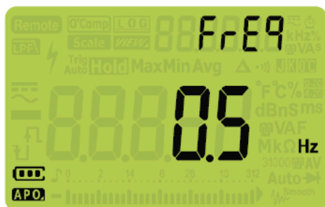
Рис. 4-13 Дисплей параметра FrEq
