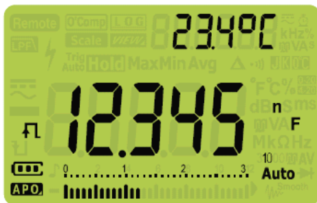
Рис. 2-24 Индикация результата измерения емкости
