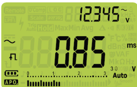
Рис. 2-38 Индикация длительности импульсов
