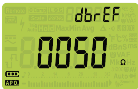
Рис. 4-7 Дисплей параметра dbrEF
