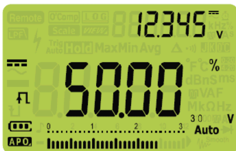
Рис. 2-39 Индикация коэффициента заполнения
