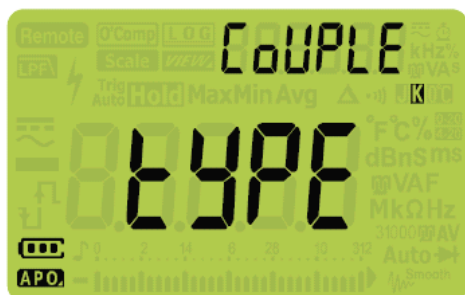
Рис. 4-12 Дисплей параметра CoUPLE
