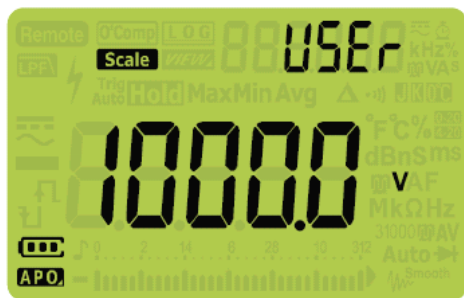
Рис. 4-19 Дисплей параметра USEr
