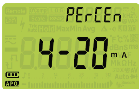
Рис. 4-11 Дисплей параметра PErCEn
