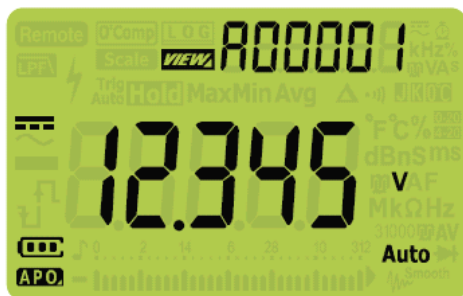
Рис. 3-10 Дисплей в режиме просмотра данных
