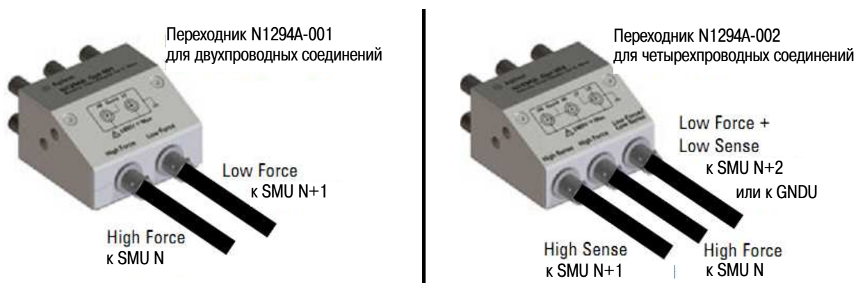
Рис. 3-7 Присоединение переходников N1294A к контактирующему приспособлению 16442B
