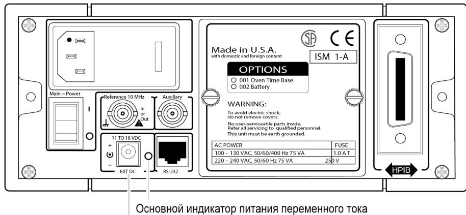
**Рисунок С-2      Разъем для подключения внешнего источника постоянного тока**
