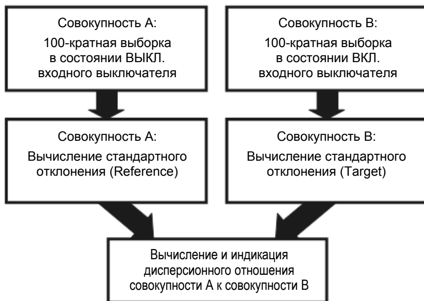
Рис. 5-15 Функциональная схема проверки уровня шума
