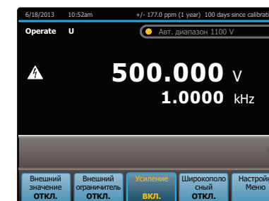
Такие особенности продукта, как подъем частотной характеристики и широкая полоса частот, легко включаются через панель инструментов с пятью кнопками, расположенную в нижней части выходного экрана.
