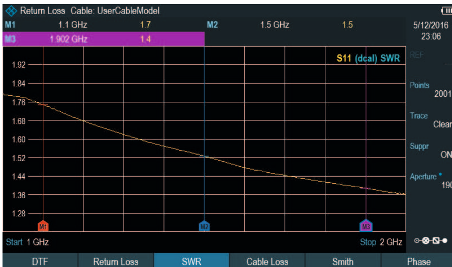
Измерение коэффициента стоячей волны по напряжению (КСВН).
