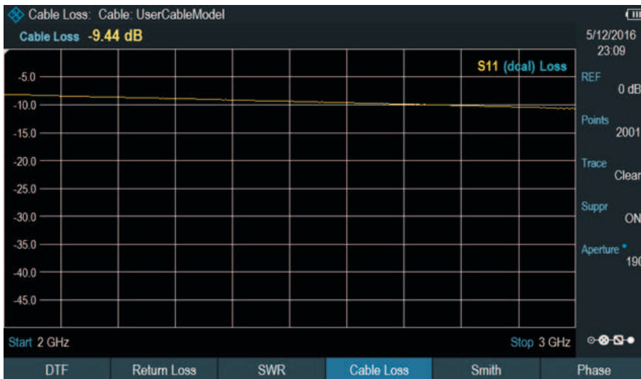
Однопортовое измерение потерь в кабеле.
