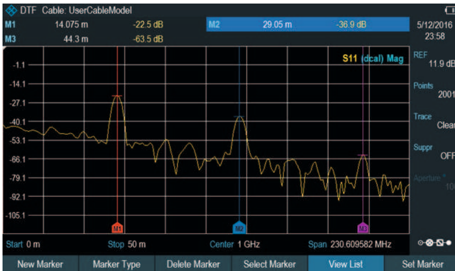
Измерение расстояния до места повреждения.
