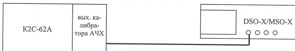
Рисунок 4 - Схема определения минимального уровня синхронизации от входов каналов осциллографа
