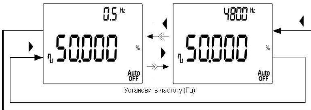
Рис. 27 Установка частоты генератора прямоугольных импульсов
