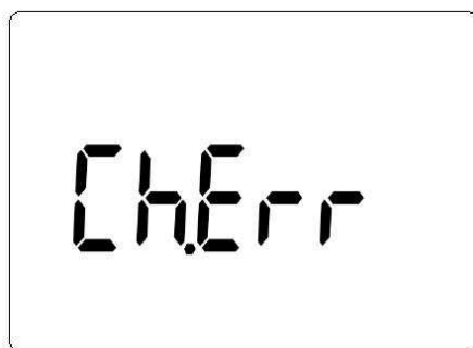
Рис. 15 Сообщение об ошибке при неправильном подключении сетевого адаптера
