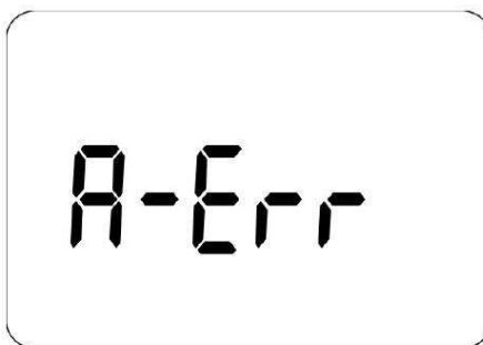
Рис. 15 Сообщение об ошибке при неправильном подключении измерительного щупа
