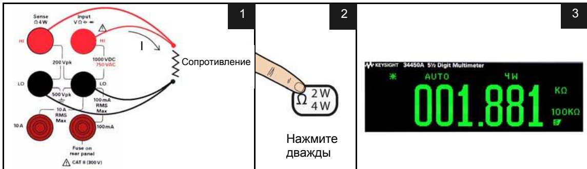
Рисунок 1-8 Подключение клемм и дисплей для 4-проводного измерения сопротивления
