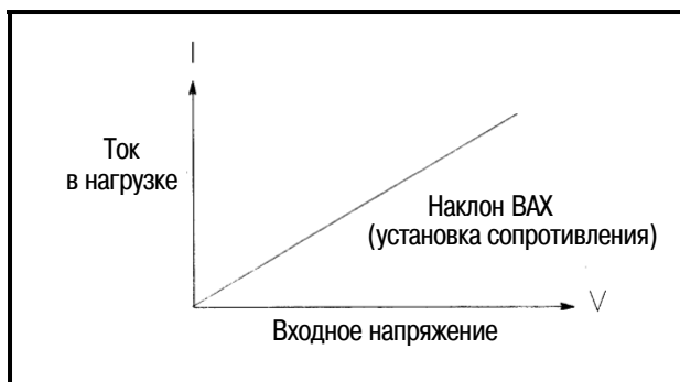
Рис. 2-2 Вольт-амперная характеристика в режиме стабилизации сопротивления
