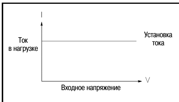
Рис. 2-1 Вольт-амперная характеристика в режиме стабилизации тока
