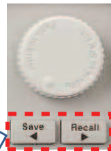
Клавиши "Save" и "Recall", расположенные под поворотной ручкой, позволяют мгновенно сохранять и вызывать до пяти полных наборов настроек измерительной схемы.
