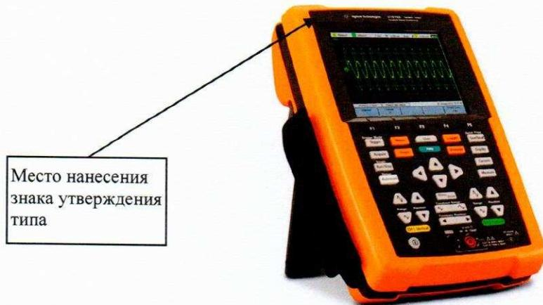
Рисунок 1 – Внешний вид осциллографа
