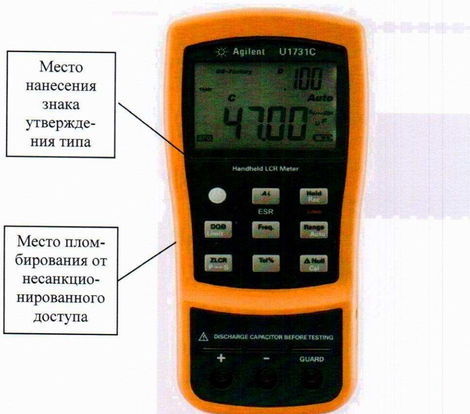
Рисунок 1 - Внешний вид измерителей и место нанесения знака утверждения типа
