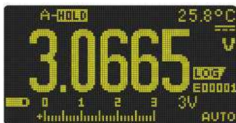
Рис. 3-9 Индикация в режиме регистрации событий
