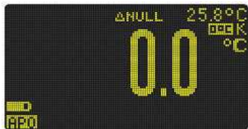
Рис. 2-28 Измерение температуры без компенсации температуры окружающей среды
