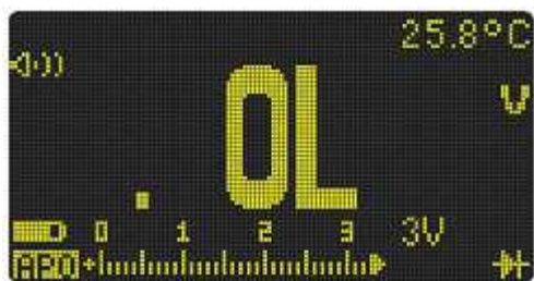
Рис. 2-19 Индикация для перегоревшего диода
