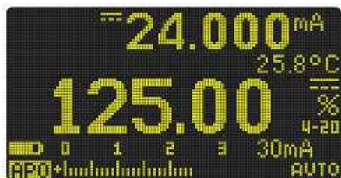
Рис. 2-33 Индикация процентного значения тока 4 ÷ 20 мА
