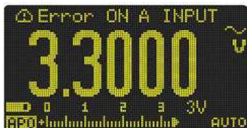
Рис. 1-4 Предупреждение о неправильном выборе входа A
