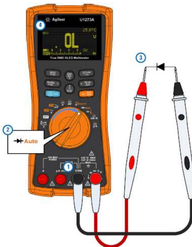
Рис. 2-21 Проверка диода при обратном смещении
