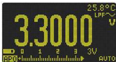
Рис. 2-3 Индикация переменного напряжения с применением фильтра нижних частот
