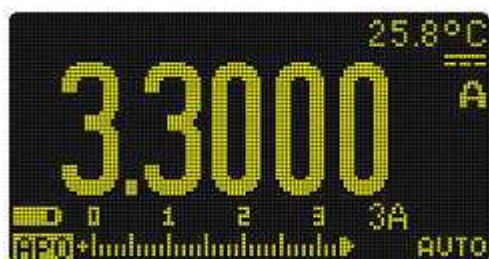
Рис. 2-29 Индикация постоянного тока
