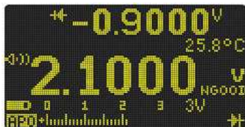
Рис. 2-23 Индикация в режиме автоматической проверки диодов – неисправный диод
