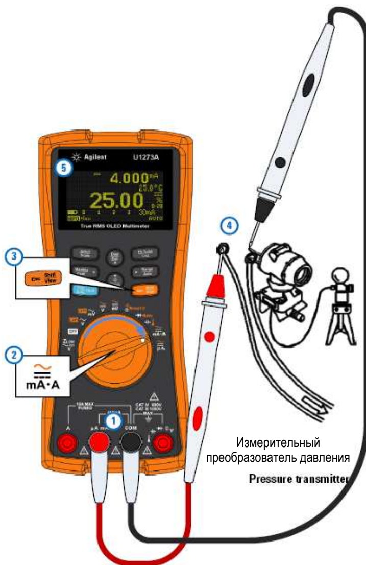
Рис. 2-34 Измерение процентного значения тока в диапазоне 0 ÷ 20 мА
