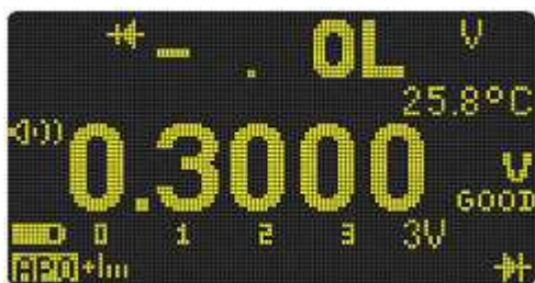
Рис. 2-22 Индикация в режиме автоматической проверки диодов – исправный диод
