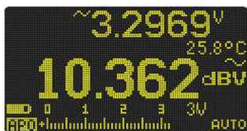
Рис. 2-9 Индикация в децибелах от вольта (dBV)
