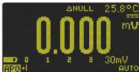
Рис. 3-1 Индикация начального значения
