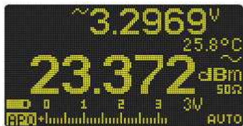
Рис. 2-8 Индикация в децибелах от милливатта (dBm)
