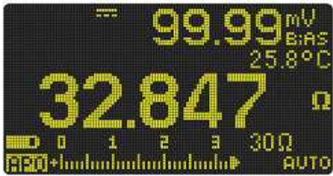
Рис. 2-15 Индикация результата измерения сопротивления в режиме Smart \Omega (с индикацией напряжения смещения)
