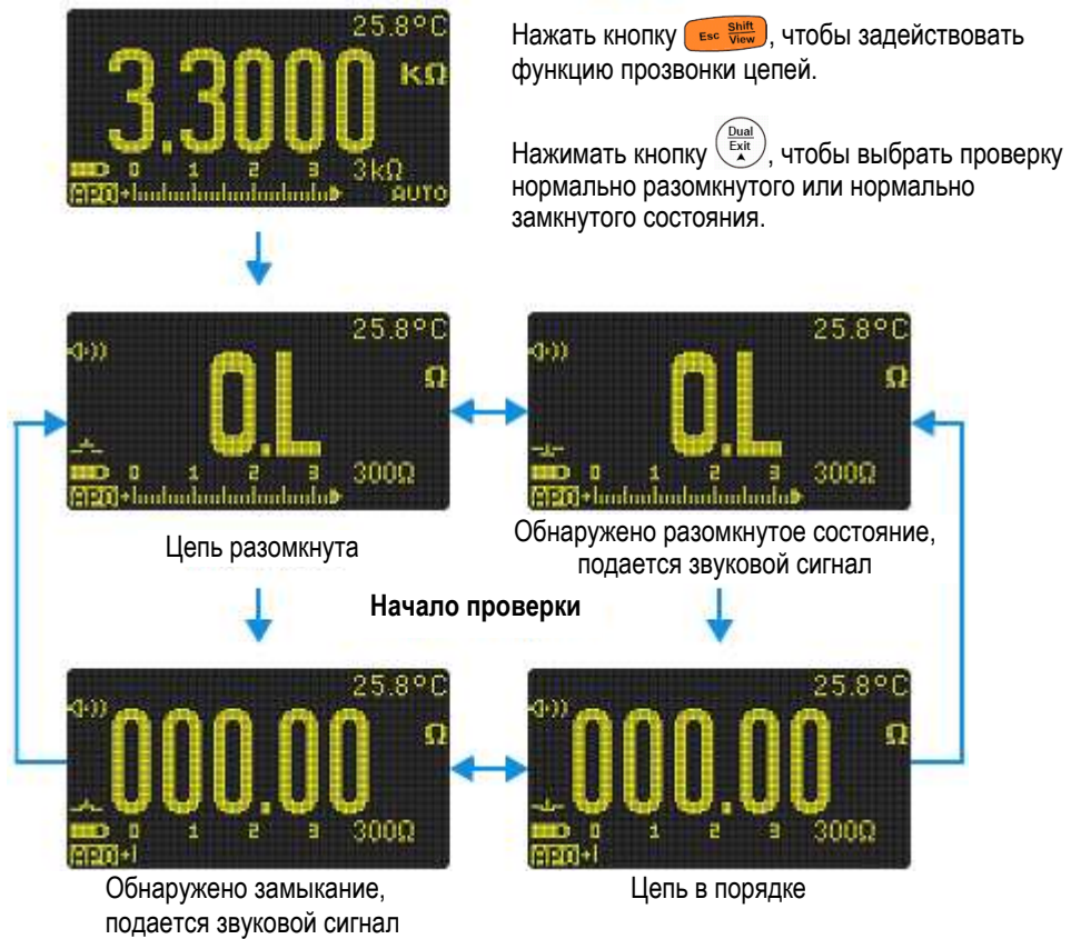
Рис. 2-13 Операции при прозвонке цепи
