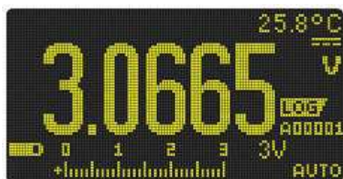
Рис. 3-8 Индикация в режиме периодической регистрации данных
