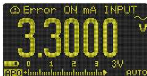
Рис. 1-5 Предупреждение о неправильном выборе входа mA
