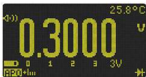
Рис. 2-18 Вид дисплея при проверке диода
