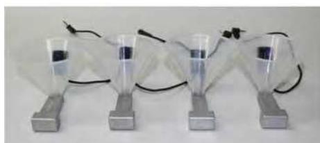
С блоком для сухой дисперсии и жёлобом для высыпания поставляются 4 вставки для загрузчика. Вы можете использовать их для регулирования скорости загрузки образца. Они имеют диаметр горлышка 1.5; 2.5; 3.5 и 4.5 мм. Для этого см. главу «Установка виброзагрузчика» на странице 61.
