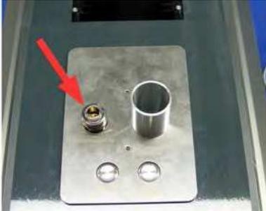
1. Подсоедините связующие элементы вставки с измерительной ячейкой к связующим элементам блока для сухого диспергирования.
