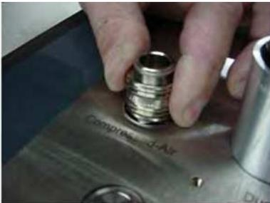
2. Подсоедините предоставленный шланг для сжатого воздуха к разъёму «Сжатый воздух» на верхней стороне блока для сухого диспергирования, просто зафиксировав его, вставив до щелчка в муфту быстроразъёмного соединения.
