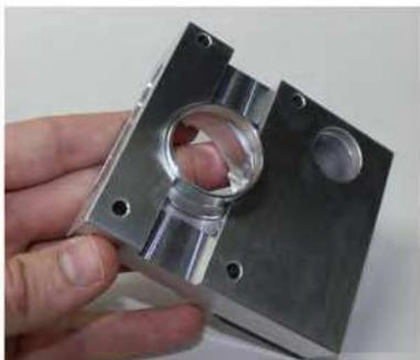
**2.** ▶ Если держать основной корпус ячейки горизонтально, заднюю линзу измерительной ячейки можно установить на её место.
