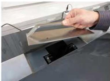
1. Поднимите крышку-щиток держателя для измерительной ячейки из измерительного блока и поместите её рядом с блоком для диспергирования.
