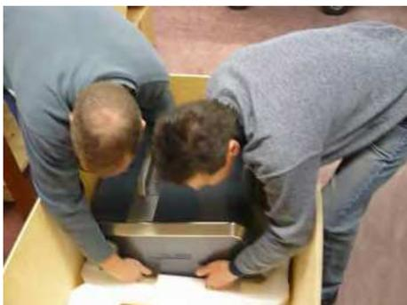
5. Поднимите измерительный блок и блок для диспергирования из пенопластовых каркасов при участии двух людей, как показано на рисунке.
