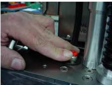
3. Подсоедините другой конец шланга для сжатого воздуха к разъёму «Сжатый воздух» вставки с измерительной ячейкой. Чтобы это сделать, нажмите на красную вставку и вставьте шланг для сжатого воздуха.
