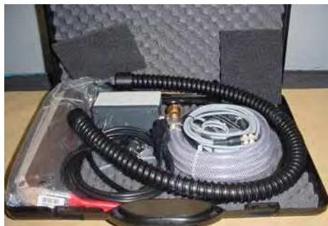
Этот чемоданчик с дополнительными принадлежностями содержит шланги для подсоединения вставки с измерительной ячейкой к блоку для сухого диспергирования и другие дополнительные принадлежности, необходимые для эксплуатации и обслуживания блока для сухого диспергирования.
