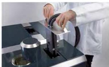
1. Сначала поместите измерительную ячейку из вставки с измерительной ячейкой блока для диспергирования в жидкой среде в измерительный блок (см. «Замена измерительной ячейки» на странице 66); если она уже там, необходимо только снять крышку измерительной ячейки.
