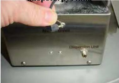
1. Подключите вибромотор воронки к виброзагрузчику.
