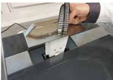
3. Вставьте вставку с измерительной ячейкой в держатель для измерительной ячейки измерительного блока. Убедитесь, что расположение измерительной ячейки в держателе правильное: линза измерительной ячейки и грань призмы должны смотреть назад.
