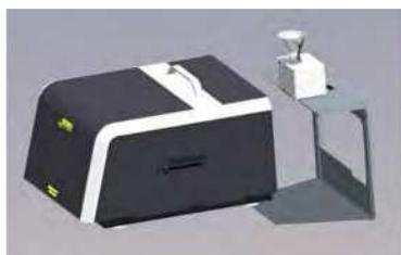
5. ➤ Втолкните держатель с загрузчиком под измерительный блок. Убедитесь, что вы не поцарапали обшивку измерительного блока.
