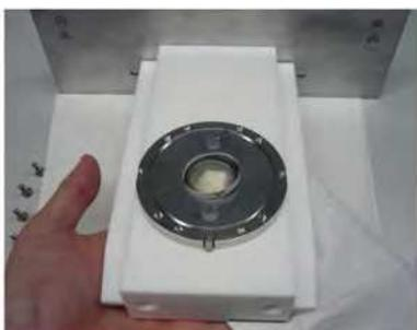
5. ➔ Поднимите податчик образца (8) и выдавите линзу измерительной ячейки (5) переднего борта (1) из измерительной ячейки с помощью бумажного полотенца. Поместите вынутую линзу (5) внешней стороной вниз на ткань для оптики.
