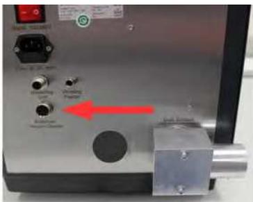
Подключите блок управления вакуумным очистителем к блоку для сухого диспергирования (Блок переключателей вакуумного очистителя).
