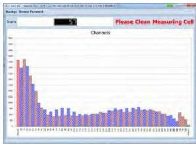
Пожалуйста, проверяйте настройку луча через каждые 20 измерений. Если световые энергии каналов возрастают во время измерения фона (можно увидеть на рисунке), вам следует очистить измерительную ячейку.
