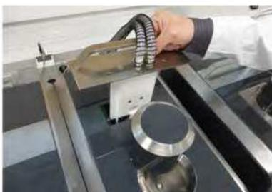
2. Потяните вставку с измерительной ячейкой вверх из держателя для измерительной ячейки блока для диспергирования.
