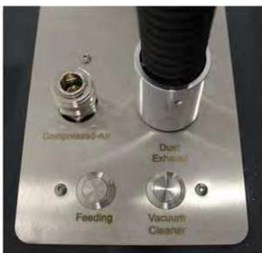
4. ➤ Подсоедините вставку с измерительной ячейкой лотка для высыпания к шлангу для вытяжки.
