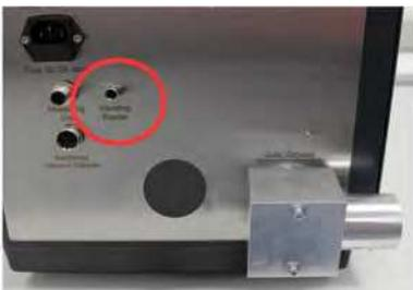
3. Соедините виброзагрузчик и блок для сухого диспергирования входящим в комплект поставки кабелем. Штекеры имеют инвертированную полярность и защиту от поворотов, поэтому проверьте положение штекера в разъёме. Плотно закрепите штекер в разъёме с помощью гайки с насечкой.
