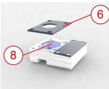
6. ➔ Поднимите фиксатор ячейки, часть 1 (6).
