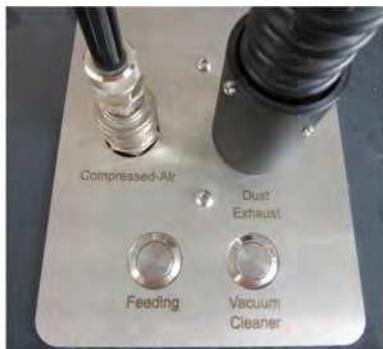
4. Подключите шланг для вытяжки к двум разъёмам «Вытяжка пыли» блока для сухого диспергирования и вставки с измерительной ячейкой.
