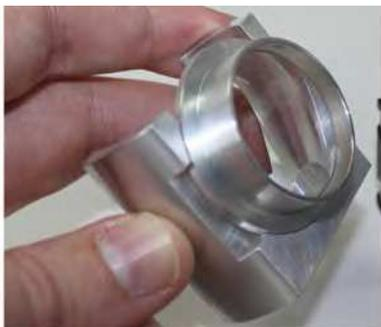
**1.** ▶ Вставьте заднюю линзу измерительной ячейки в желобок вставки для фокусировки воздуха, в который задняя линза измерительной ячейки обычно помещается после установки.
