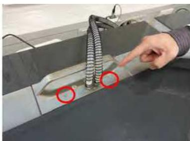
4. Вставьте вставку с измерительной ячейкой в держатель для измерительной ячейки измерительного блока. Убедитесь, что расположение измерительной ячейки в держателе правильное: линза измерительной ячейки и грань призмы должны смотреть назад.
