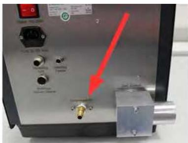
Подключите ваш блок для сжатого воздуха к соединительному разъёму «Сжатый воздух» (6) блока для сухого диспергирования (шланг для сжатого воздуха длиной 3 м с быстроразъёмными соединениями, включёнными в комплект поставки).
