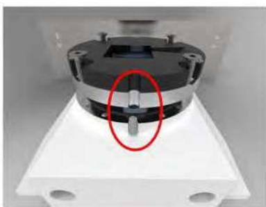
6. ➤ Затем осторожно соедините обе половины измерительной ячейки. Обратите внимание на правильное положение винта без головки (см. рисунок).
