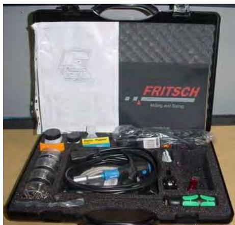
Этот чемоданчик с дополнительными принадлежностями содержит вспомогательные материалы и инструменты для подключения измерительного блока к блокам для диспергирования и для работы с блоком для диспергирования в жидкой среде.
