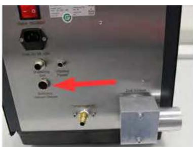
Подключите блок управления вакуумным очистителем к блоку для сухого диспергирования (Блок переключателей вакуумного очистителя).
