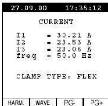
Пример изображения экрана в режиме 3ф 3 пр. сети
