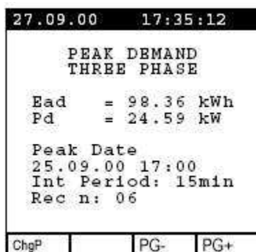
Пример экрана в режиме ОПРЕДЕЛЕНИЯ ПИКОВЫХ НАГРУЗОК
