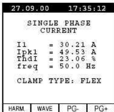
Пример изображения экрана в режиме 1ф сети
