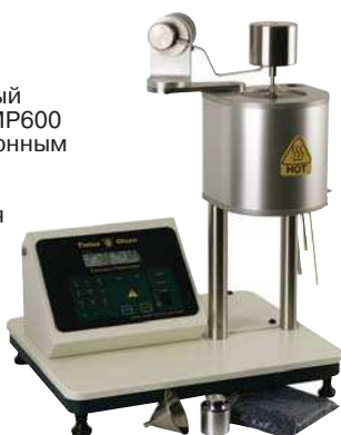
Экструзионный пластометр MP600 с устройством автоматической поддачи и подъема грузов
