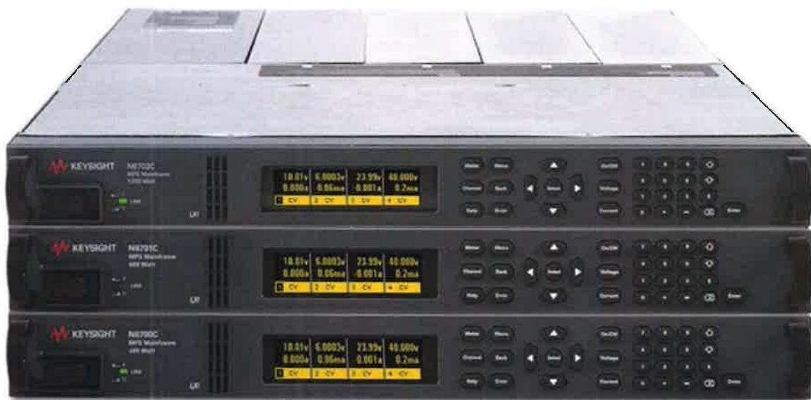
Рисунок 3 – Общий вид базовых блоков N6700C, N6701C, N6702C. Передняя панель
