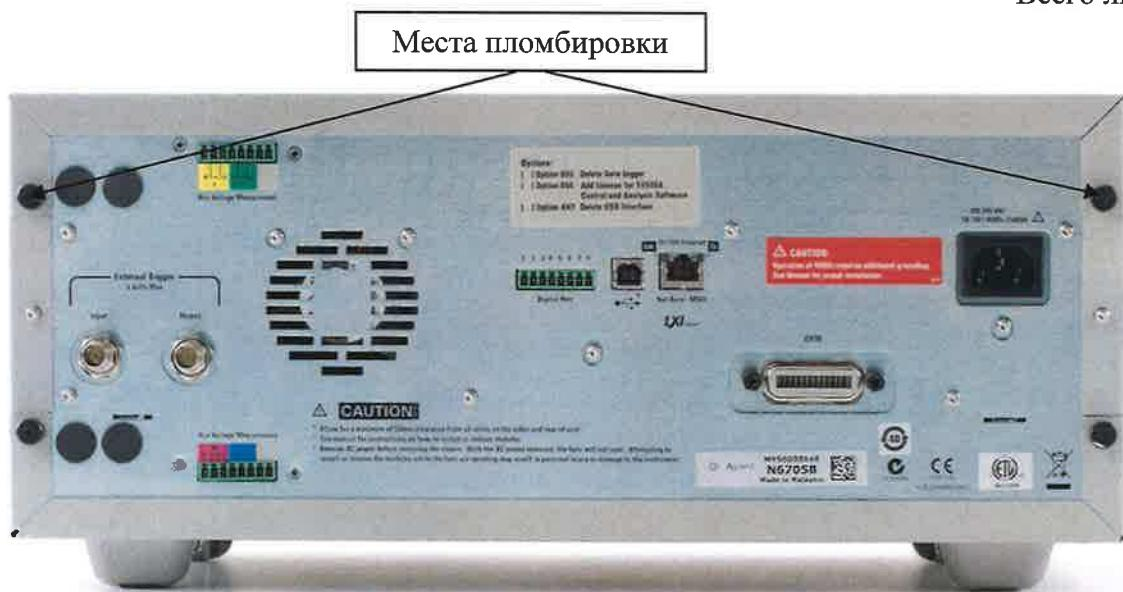
Рисунок 6 – Общий вид базовых блоков N6705B. Задняя панель
