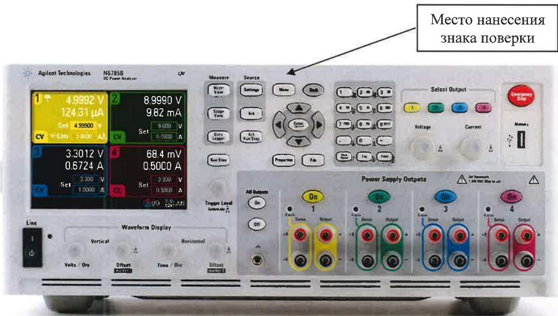
Рисунок 5 – Общий вид базовых блоков N6705B. Передняя панель
