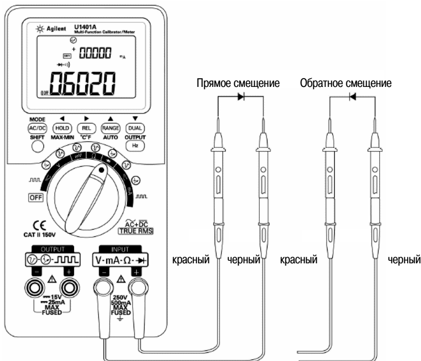
Рис. 5-6 Проверка диода
