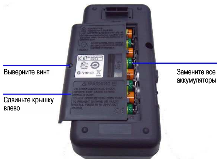
Рис. 6-1 Замена аккумуляторной батареи
