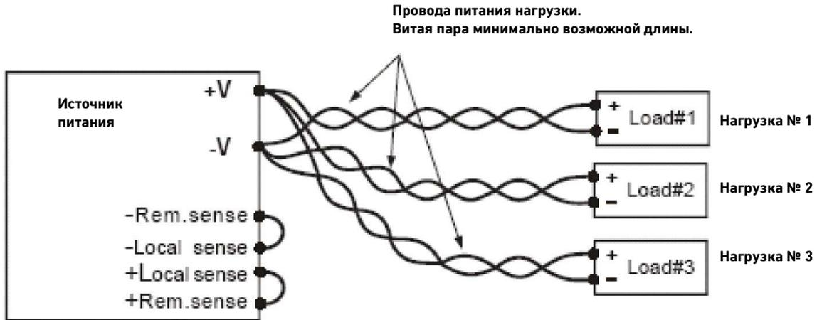
В случае применения распределительных клемм, удаленных от прибора, соедините выходные клеммы с удаленными распределительными клеммами парой скрученных и/или экранированных проводов, как показано на следующем рисунке. Присоедините каждую нагрузку к распределительным клеммам отдельными проводами.
