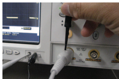
Рисунок 3-1. Используйте небольшую отвёртку для настройки конденсатора переменной ёмкости пробника.
