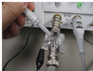
Рисунок 2-2. Причиной дополнительной нагрузки пробника является длинный проводник заземления.
