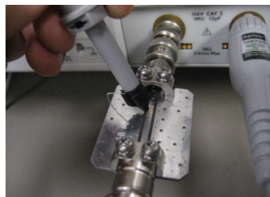
Рисунок 2-3. Уменьшение нагрузки пробника за счёт использования более короткого проводника заземления.
