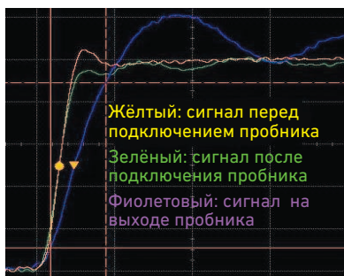
Рисунок 1-1. Сравнение пассивного и активного пробников при измерении сигнала, который имеет время нарастания 600 пс.
