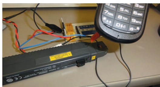
Рисунок 4-2. Простой способ измерить ток с помощью осциллографа — использовать пробник с токоизмерительными клещами Keysight 1147V или токовый пробник N2893A.
