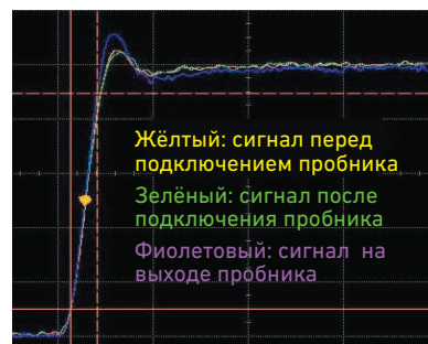
Рисунок 1-1. Сравнение пассивного и активного пробников при измерении сигнала, который имеет время нарастания 600 пс.
