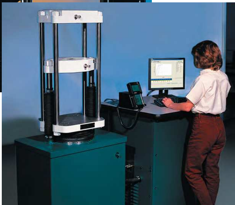
Рис. 2. Super "L60" (300 кН) с выносным пультом и компьютерной системой управления
