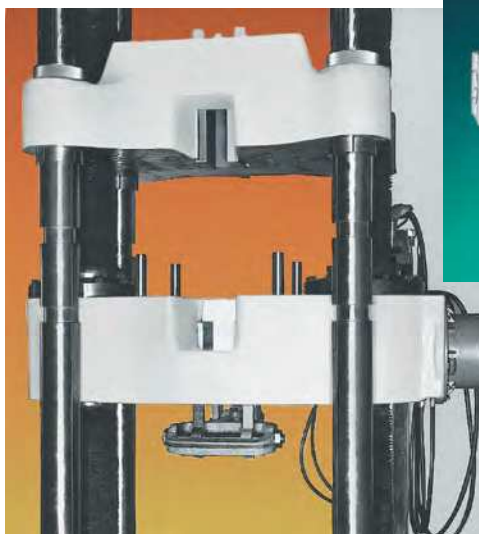
Рис. 15. Траверса полуоткрытого типа с захватами рычажного типа
