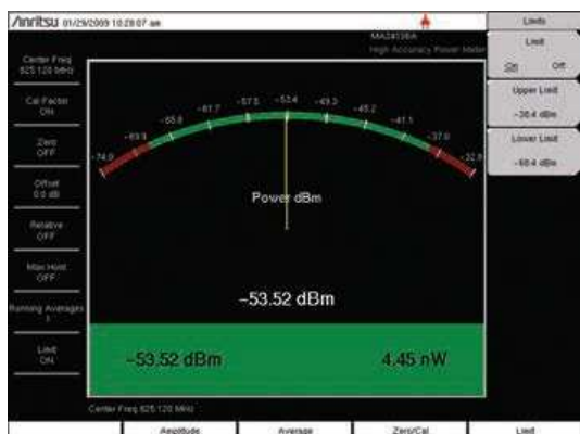
Опция 19 «Высокоточный измеритель мощности» использует датчики мощности с подключением по USB и обеспечивает получения точных данных в диапазоне до 26 ГГц
