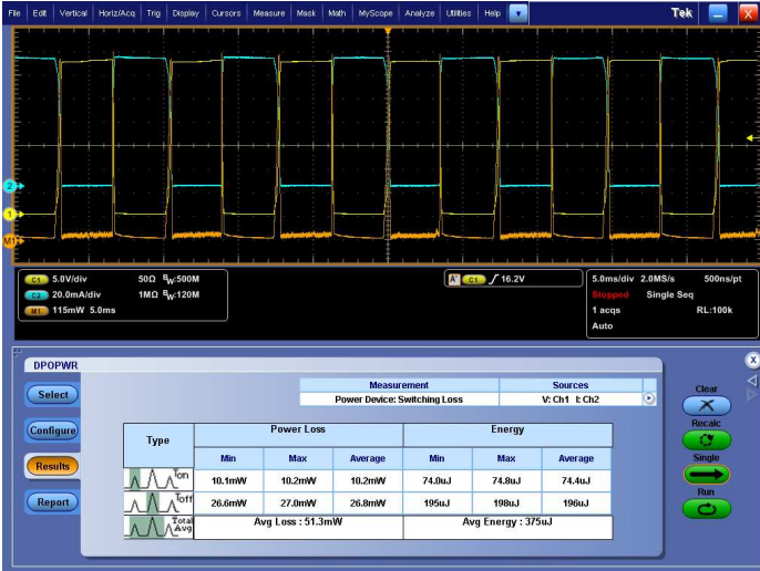
Измерение коммутационных потерь. ПО для расширенного анализа джиттера и построения глазковых диаграмм.
