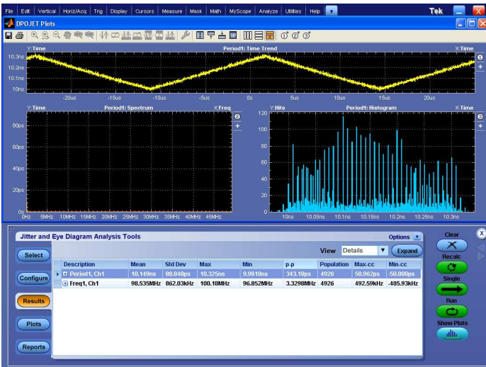
Расширенный анализ, измерения джиттера, глазковых диаграмм и временных характеристик.
