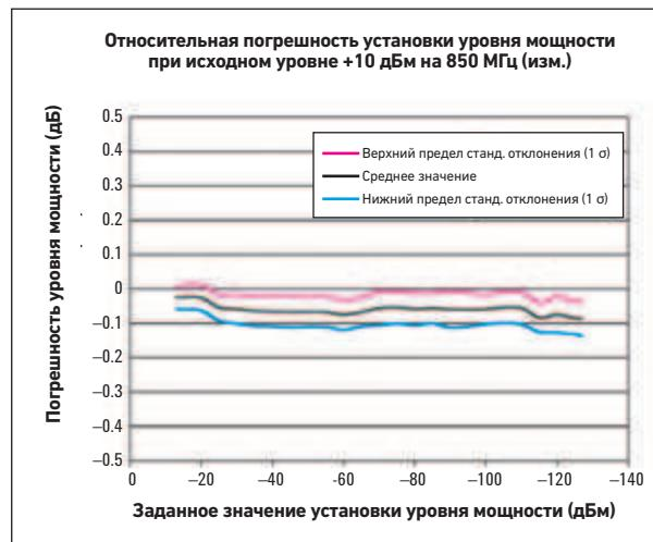
Повторяемость является мерой способности прибора возвращаться на данную установку уровня мощности после произвольно установленной другой частоты и мощности. Не следует путать этот параметр с абсолютной погрешностью установки уровня мощности.
