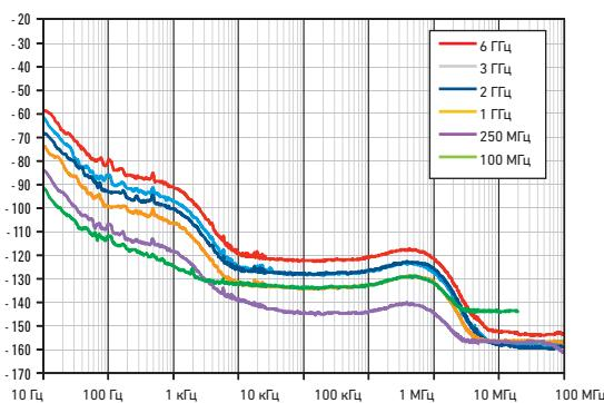
Абсолютный фазовый шум при I/Q-модуляции (изм.)
