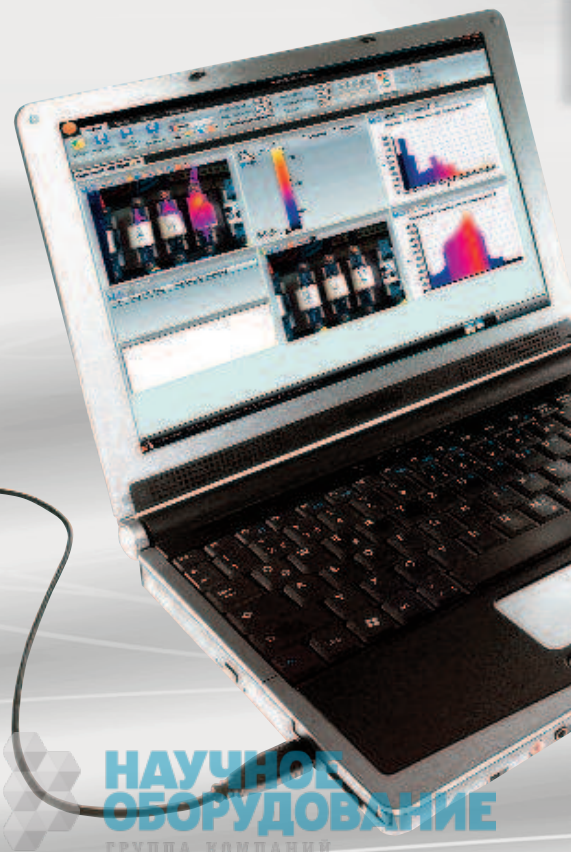
ПО для ПК: функция наложения снимков TwinPix
