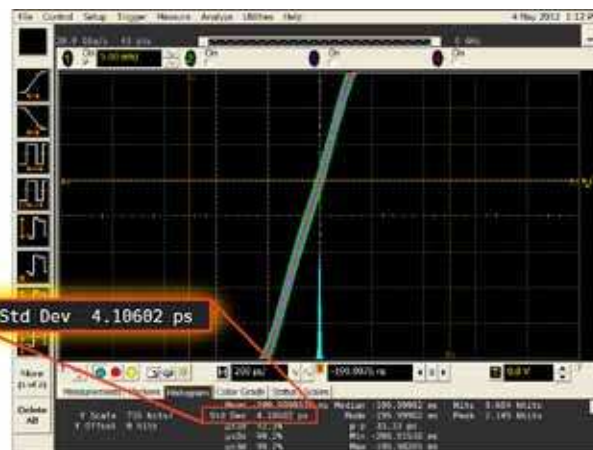
Рис. 1. Измерение джиттера генератора сигналов 33522А
